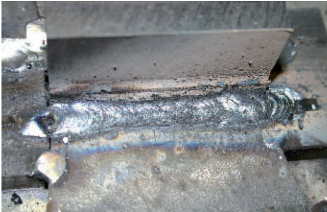
Bild 4. Reparaturschweißen (links) und entsprechende Schweißlage (rechts) Fig. 4. Repair welding (left) and appropriate weldings layers (right)
