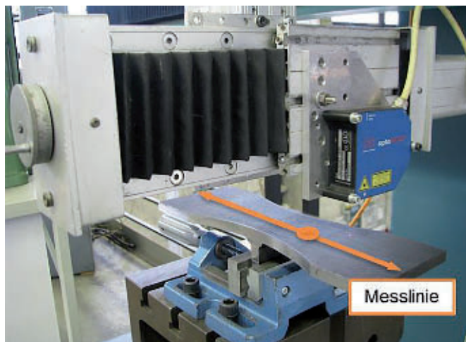
Bild 11. Winkelverzugberechnung mit Lasertriangulation [1] Fig. 11. Measurement of angular misalignment with laser triangulation [1]
