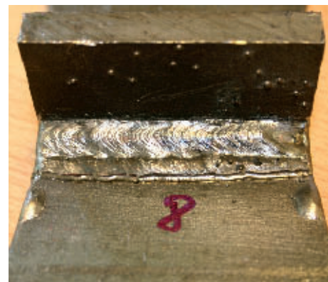
Bild 5. Ansicht auf die Schweißnähte nach der Sanierung Fig. 5. View of seams after repair
