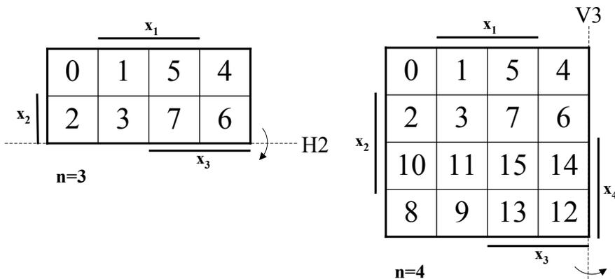
➤ Konstruktion von KV-Diagrammen mit wachsendem n
