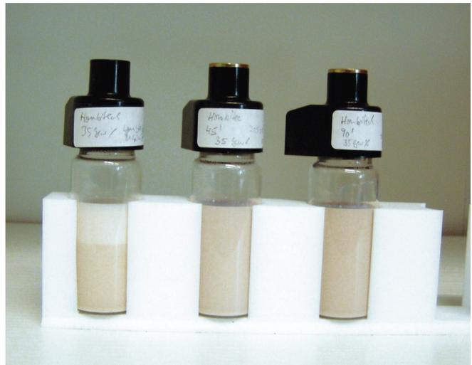
Abbildung 4.4 Aufnahmen der drei Proben aus Abb. 4.3 nach 30 Stunden Sedimentation
