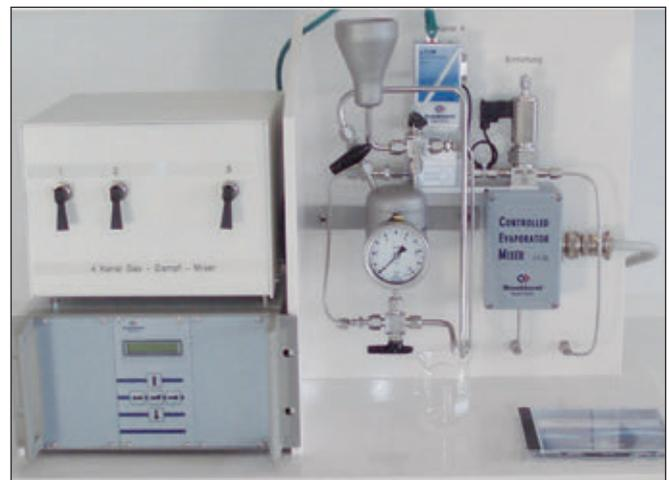
**Abbildung 3** Gas-/Dampf-Mischsystem ermöglicht entsprechend der konkreten Konfiguration die Verwendung gemischter Gase bzw. Dämpfe im AUTOSORB-iQ-C/TPX
