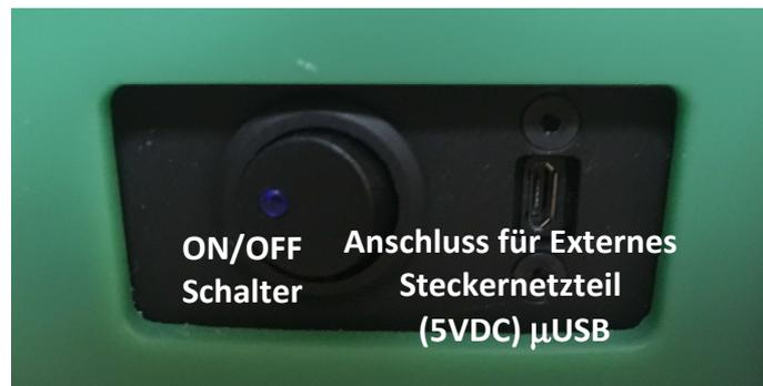
Abb. 2: Netzteilanschluss und Hauptschalter
