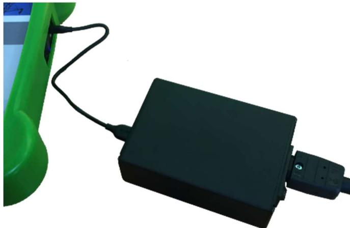
Auf diese Weise wird das Gerät permanent über den Messeingang mit Strom versorgt und kann so lange benutzt werden, wie das lineare Netzteil angeschlossen ist. Die Batterie ist in diesem Fall nicht in Betrieb.
