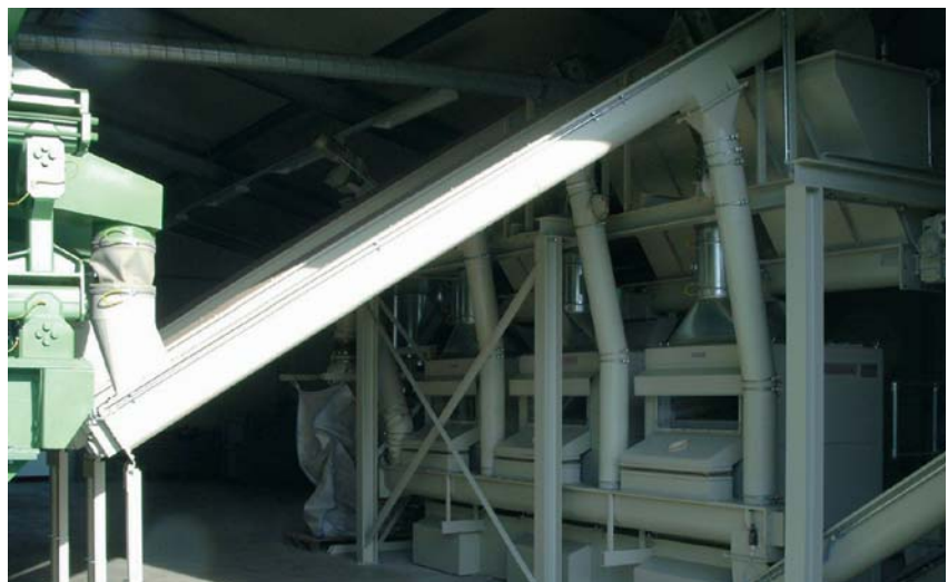
Die drei Trenntische der Mechanischen Stofftrennung der Demonstrationsanlage: Jeder Trenntisch wurde mit einer anderen Siebfraktion besetzt und trennte das getrocknete Material in Brennstoffe und Mineralstoffe.
