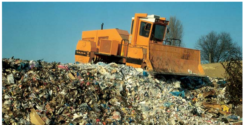
Bis zum Jahre 2005 wurden nicht vorbehandelte Abfälle auf der Deponie Kahlenberg mit schweren Maschinen eingebaut.
