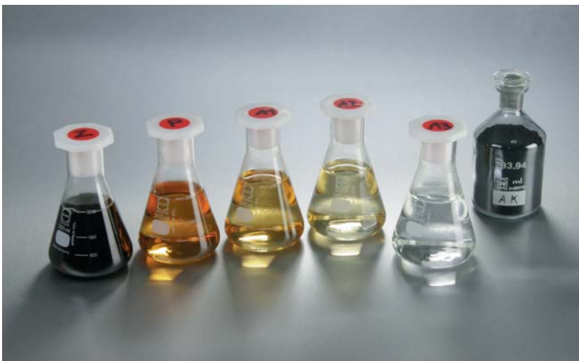
Das dunkle, belastete Abwasser wird über mehrere Reinigungsstufen so gut geklärt, dass es in die Kanalisation eingeleitet werden kann. In der rechten Flasche ist die im letzten Reinigungsschritt eingesetzte Aktivkohle zu sehen.
