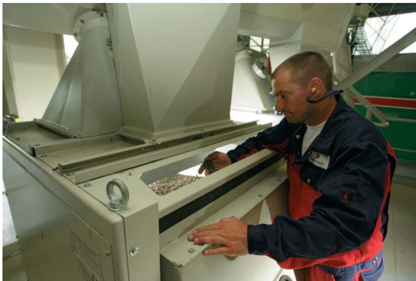
Ein Mitarbeiter des ZAK beurteilt am Trenntisch die Qualität der Stofftrennung.
