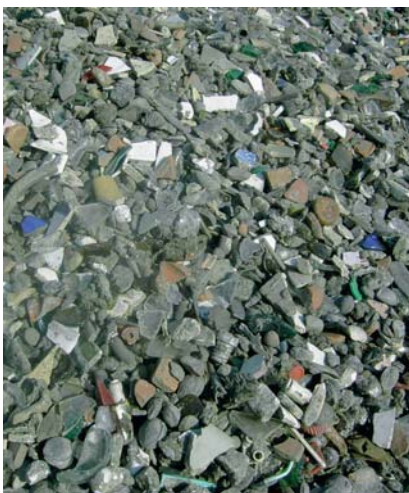
Die abgetrennten Mineralstoffe erfüllen die strengen Kriterien zur Ablagerung auf Deponien.
