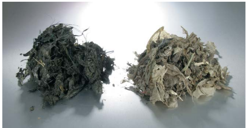
Jede Tonne des feuchten Materials (links) gibt in der biologischen Trocknung über 300 Liter Wasser ab. Rechts ist das getrocknete Material zu sehen.
