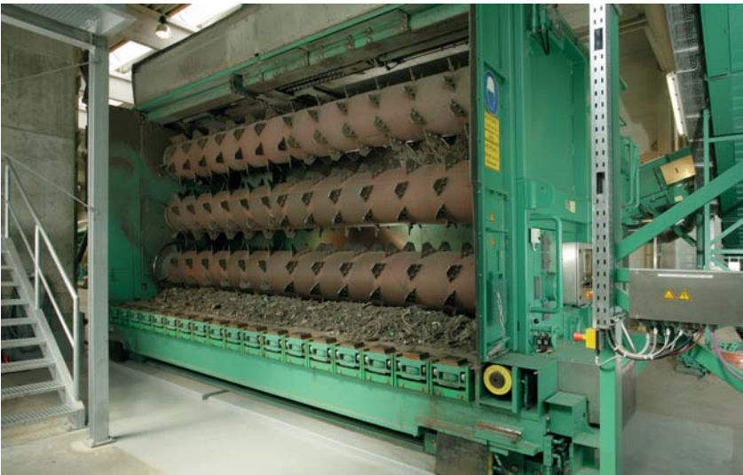
Einblick in das Innenleben des Tunnelaustragsgerätes: Die drei Walzen fräsen das Material aus dem Tunnel ab.
