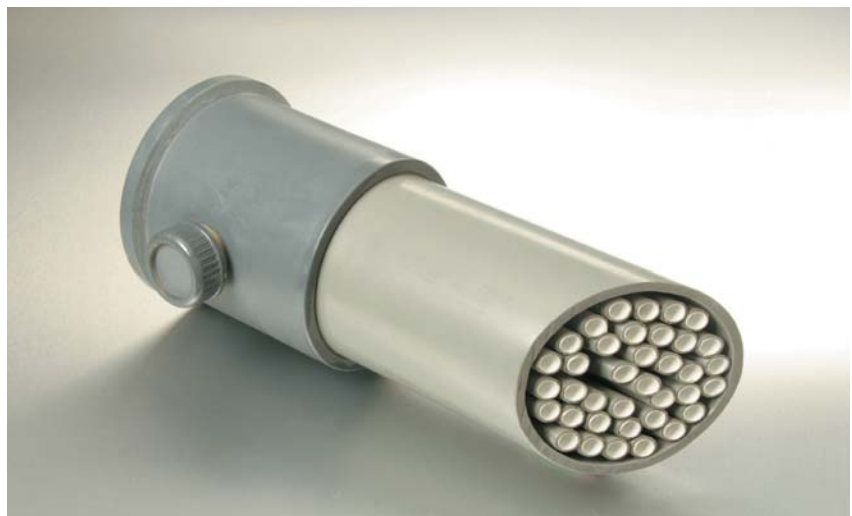
Das Schlamm-/Wasser-Gemisch wird durch die im Bündel angeordneten Rohrmembranen gepresst. Nur das gereinigte Wasser kann die Membrane passieren. Der Schlamm wird vollständig zurückgehalten.
