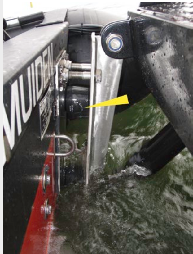
Seewasserbeständige, robuste TUBUS Strukturdämpfer aus Co-Polyester Elastomer lassen Boote und Besatzung sicher andocken Wals Diving and marine service, 1970AC IJmuiden, Niederlande
