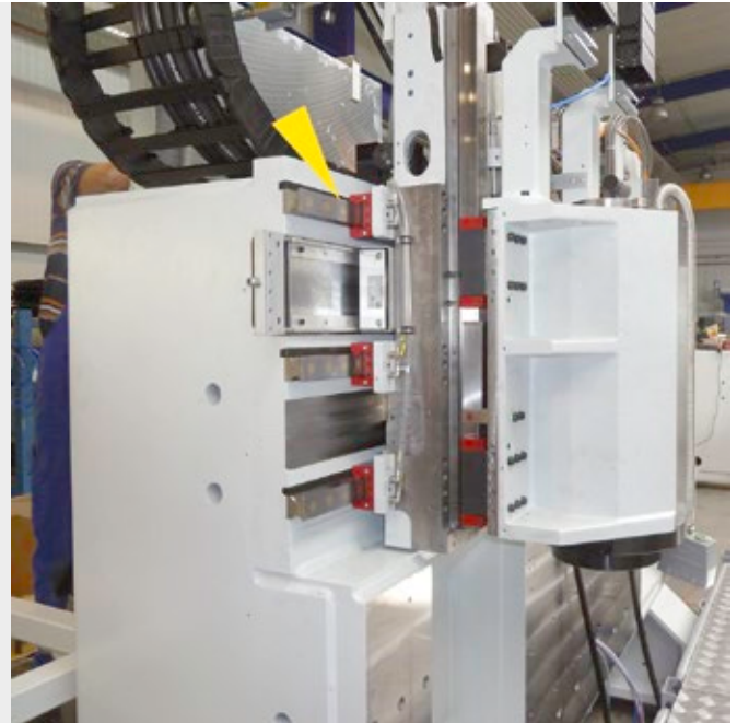
Klemm- und Sicherheitselemente von ACE halten Achsen in Sonderdrehmaschine felsenfest und sichern die zuvor festgelegten Positionen horizontal wie vertikal RASOMA Werkzeugmaschinen GmbH, 04720 Döbeln, Deutschland
