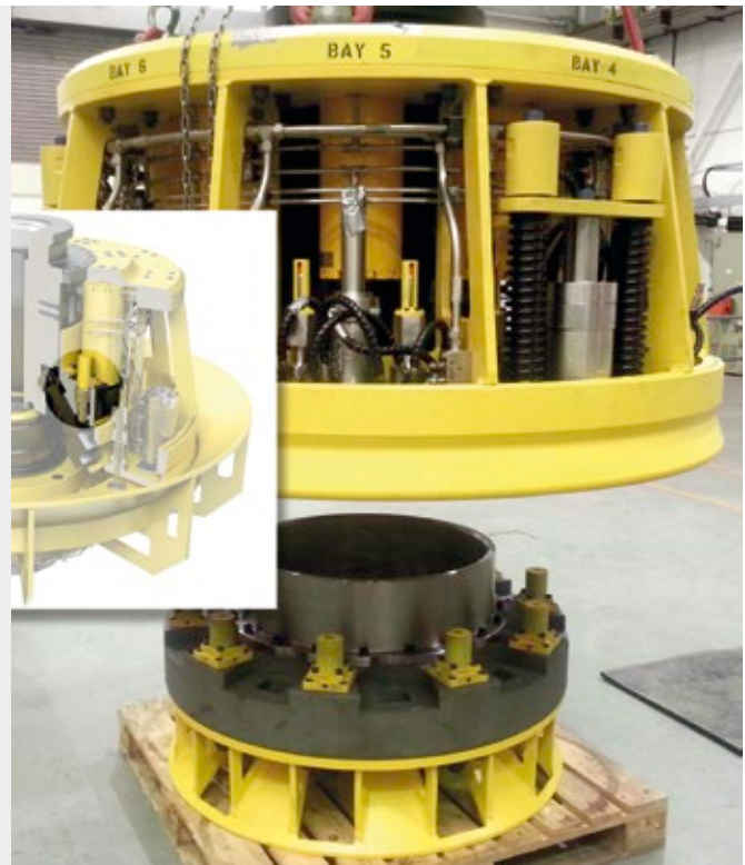
MAGNUMS ermöglichen zur Not schnelle Trennung der Pipelines von Bohrseln Subsea Technologies Ltd, Aberdeen, AB12 3AY, Vereinigtes Königreich
