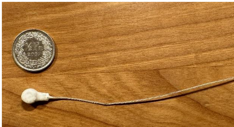
Abbildung 6: Radiomarkierung (Nanotag, NTF-3-2) mit Antenne (Gewicht: 0.57 g)
