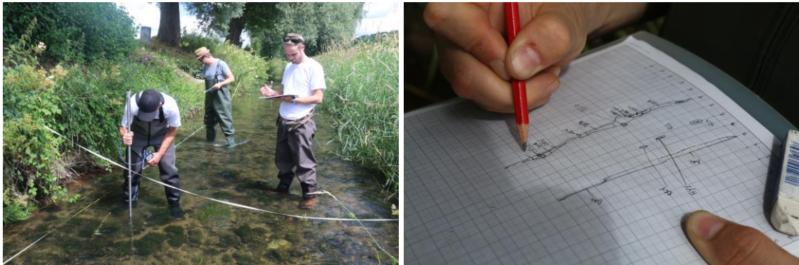
Abbildung 3-6. Messungen der Wassertiefe und der Fließgeschwindigkeit entlang von Querprofilen (links) und zwei dimensionale Kartierungen der Habitate auf Millimeterpapier (rechts).
