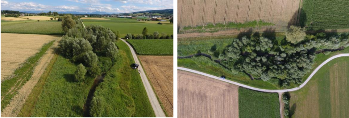
Abbildung 3-4. Strecke 3 liegt im Bereich mit etwas mehr Gewässerraum und wurde als verzweigtes Gerinne ausgestaltet.
