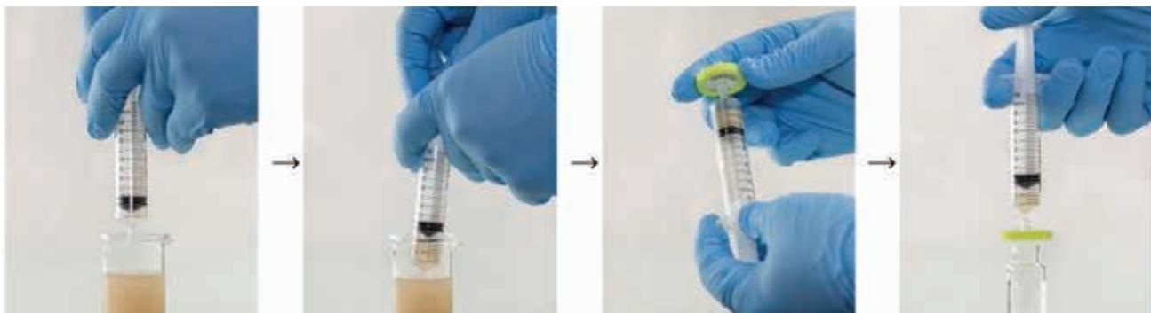
Ziehen Sie zuallererst 1 ml Luft in die Spritze, bevor Sie die Probe aufziehen. Auf diese Weise minimieren Sie das Zurückhalten von Flüssigkeit.
