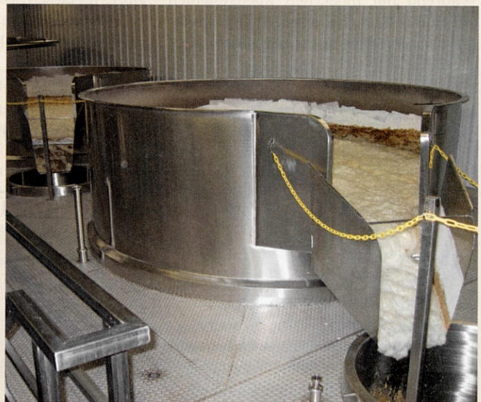
Die New Glarus Brewing Company in Wisconsin hat auch offene Gärbottiche im Einsatz
