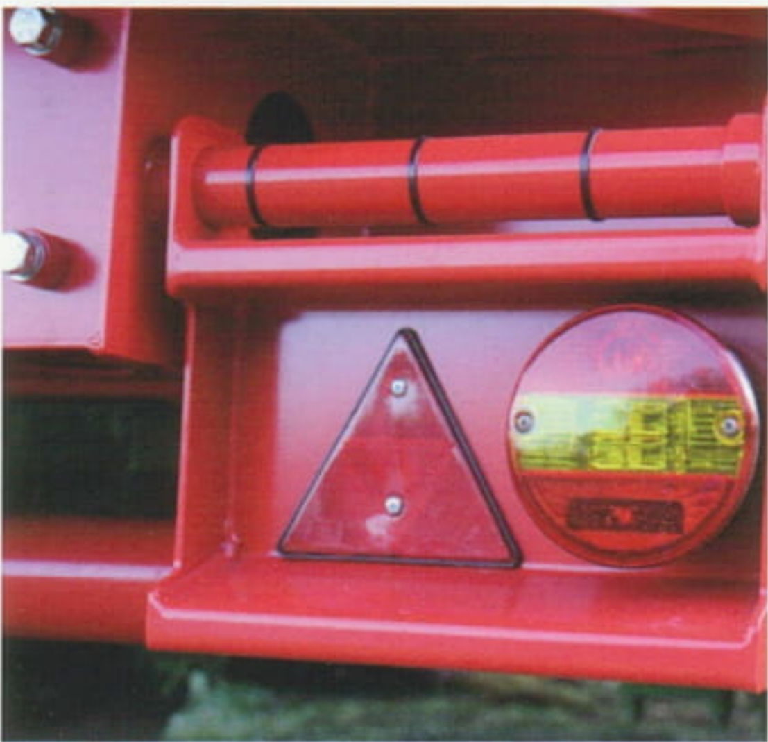
Pendelnd aufgehängte Rückleuchten (Schutzgitter als Zubehör).
