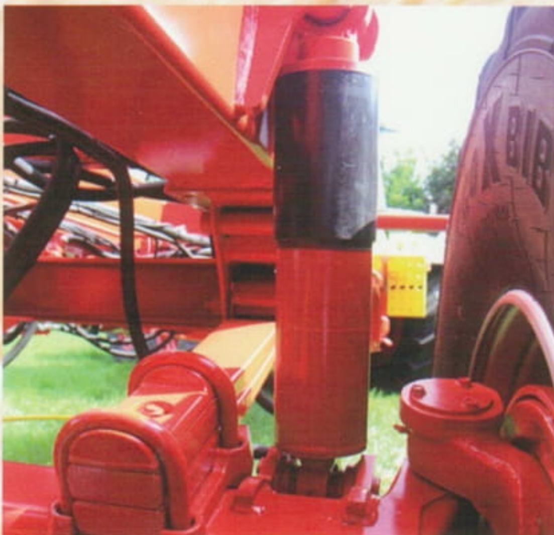
Fahrwerk mit hydropneumatischer Fahrwerksfederung, inklusive Liftachse.
