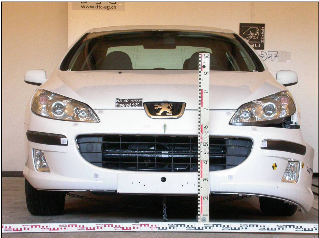
Bild 2: Beschädigungen im Frontbereich des Peugeot
