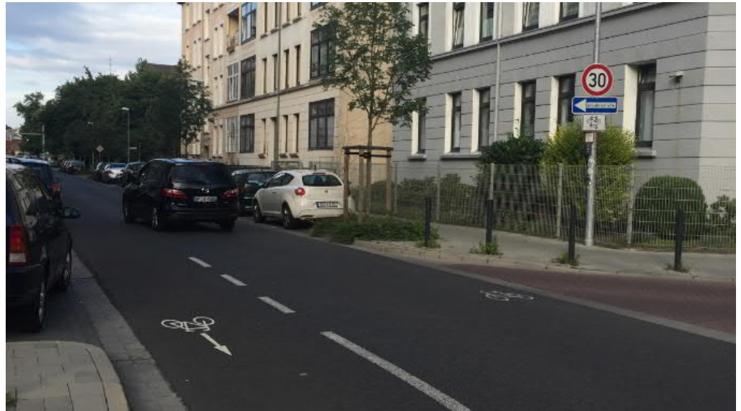
Abb. 18 Markierung von Fahrradpiktogrammen auf der Fahrbahn (Braunschweig)
