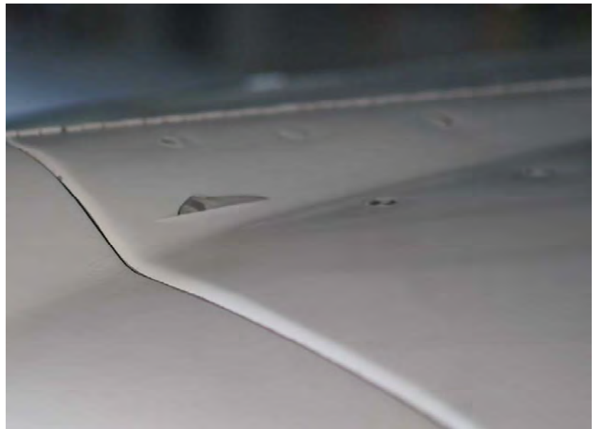
Lack-Abplatzer wie diese erfordern mehr als reines Aufpolieren und Versiegeln. Für den Erfolg der Maßnahme ist es entscheidend, die richtigen Farböne für Ausbesserungsarbeiten bereitzuhalten.
