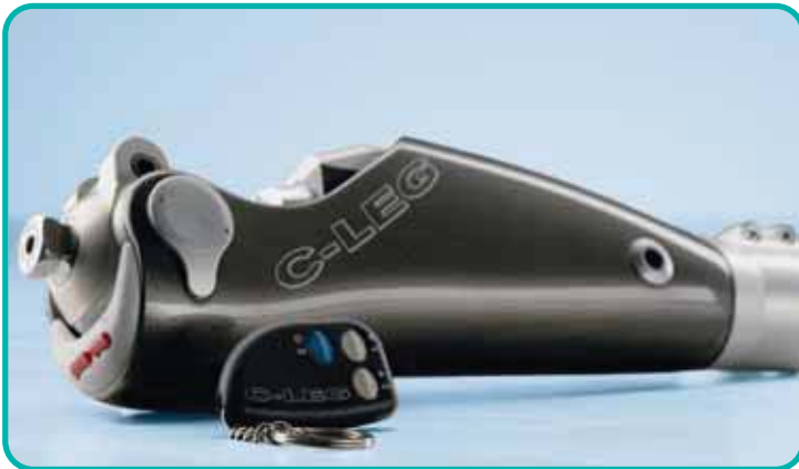
Computergesteuertes Beinprothesen-System C-Leg.
