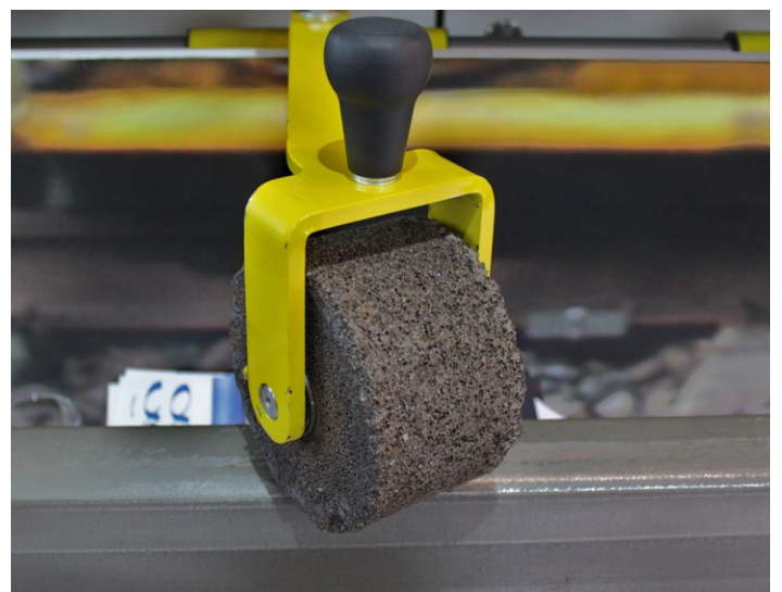
Bild 5-4: Modell eines Schleifstein vom Typ „High Speed Grinding“ (HSG)
