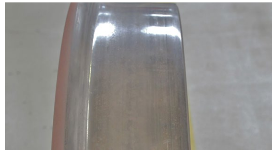
Bild 2-8: Glatte Lauffläche von Rädern
