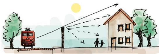
Bild 5-15: Schallschutzwände in unterschiedlicher Entfernung zum Gleis
