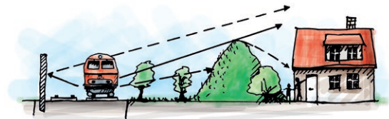
Bild 5-12: Schallschutzwand, Reflexionen an der Schallschutzwand
