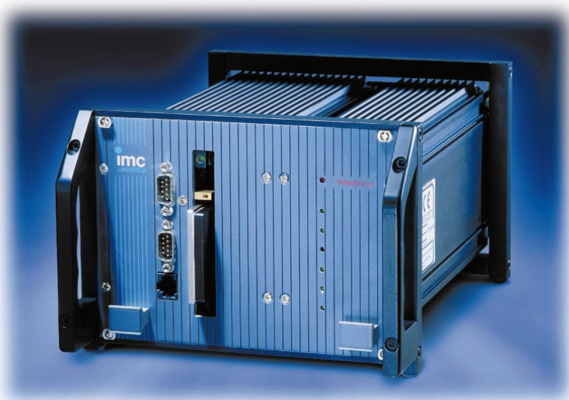
Bild 1: \mu -Musycs als universale Messhardware und Entwicklungsplattform für Prüfsandaufgaben
