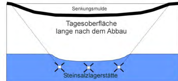
Kammerpfeilerbau in einer Steinsalzlagerstätte
