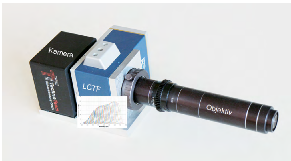
Abb. B2.3-8 Bildauffösendes Farbmesssystem mit durchstimmbarem Filter [TTG-2017].
