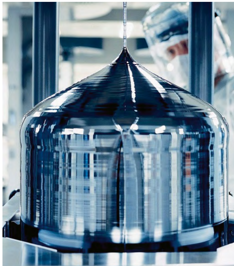
Abb. C1-1 Silizium-Einkristalle als Ausgangsmaterial für Halbleiter-Bauelemente erreichen „Baumgröße“ [SILT-2017].
