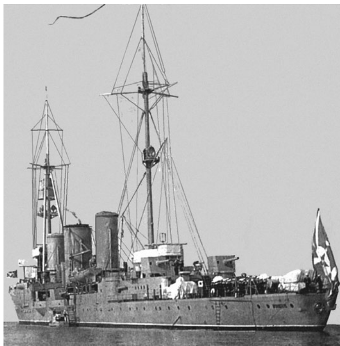
Abb. 2: Die PROFINTERN 1929, noch im Indienstellungszustand. Unter den auf der Schanz sichtbaren hellen Persennings verbergen sich drei Drillings-Torpedorohrsätze. Sie wurden später weggenommen, um die Bedienung der ebendort postierten Fla-Waffen und die Minenhandhabung nicht zu behindern (vgl. Risszeichnung PROFINTERN)
