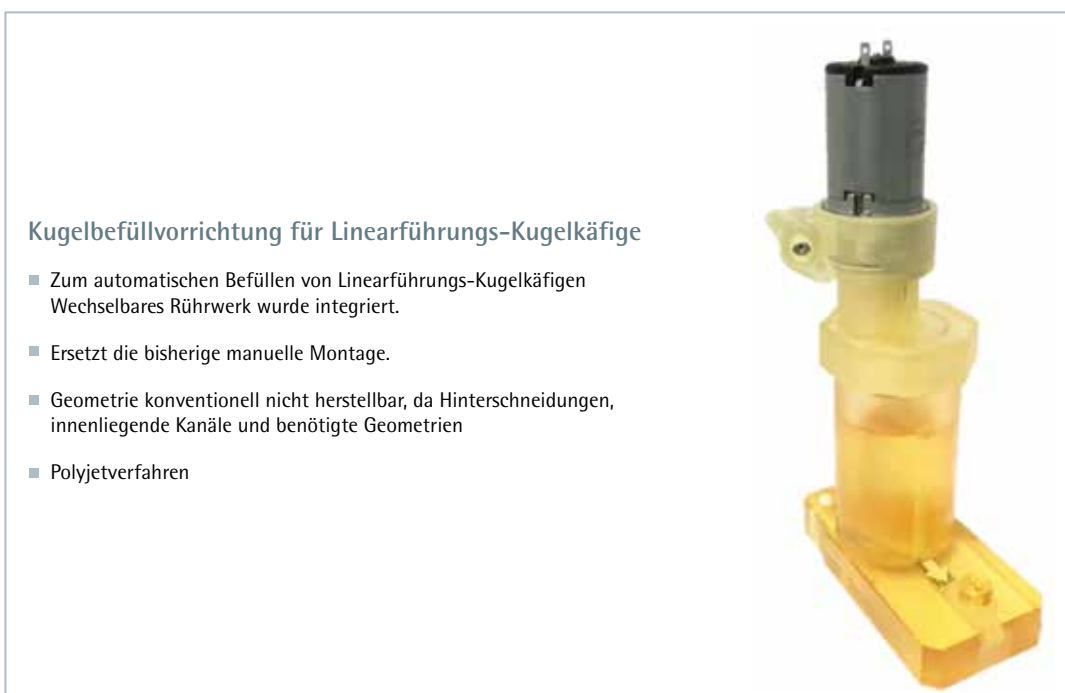
Abb. 3: Beispiel eines mit 3D-Technik hergestellten Teils
