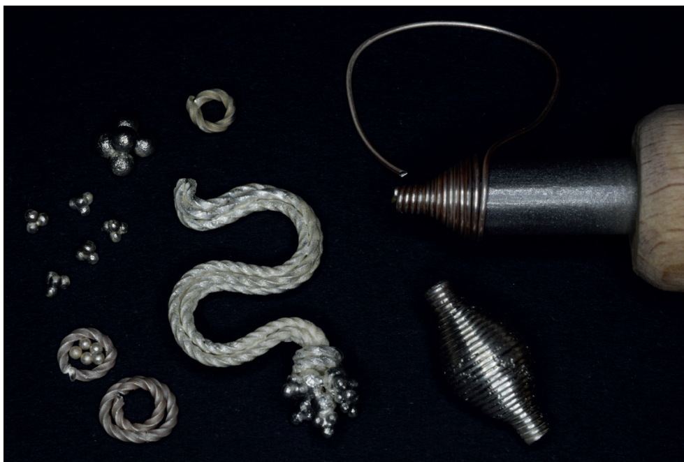
Abb. 29. Herstellungsetappen des Schließhakens von Müller B und der doppelkonischen Perle (Silberprobe 980; Filigran und Granulation). Foto: J. Strobin.
