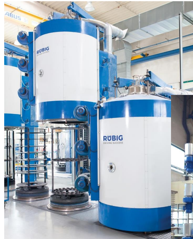
PN- und Beschichtungsanlagen Duplex DLC Xtended : Ofenraum bis zu d=150cm;h=240cm
