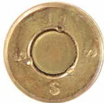
Der Bodenstempel der Hülse zeigt, dass es eine S-Hülse ist (S), die in der Munitionsfabrik Spandau (S) hergestellt wurde, und zwar im Mai (S) des Jahres 1911 (11).
