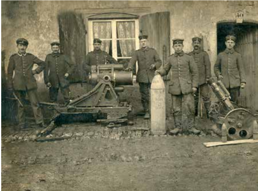
Minenwerfer gab es in drei Gewicht- klassen: Hier lassen sich Soldaten mit einem schweren und einem leichten Minenwerfer sowie der jeweiligen Mu- nition ( Wurfminen ) fotografieren.
