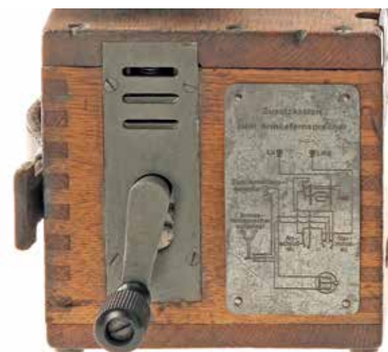
Zusatzkasten mit Schaltbild.
