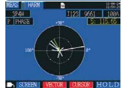
Graphanzeige für Phasenwinkel der harmonischen Leistung (Vektoranzeige)
