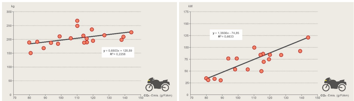
Abbildung 26: Regressionsanalyse Motorräder: Gesamtgewicht vs. CO 2 -Emissionen (links) bzw. Motorleistung vs. CO 2 -Emissionen (rechts)
