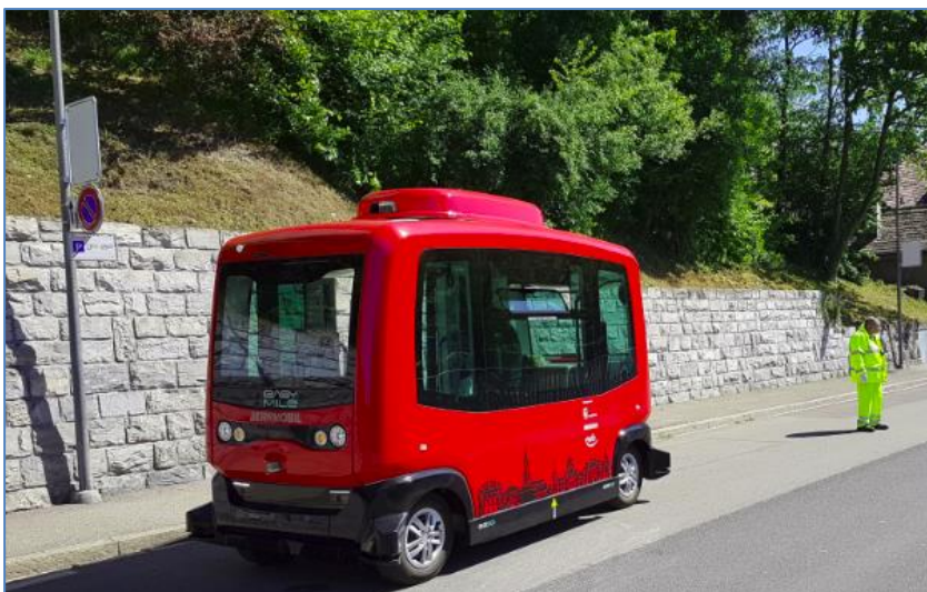
Abbildung 18: EZ10 in der Aarstrasse, links eine Orientierungstafel für die auf dem Dach montierten LIDAR-Sensoren (Mai 2019)
