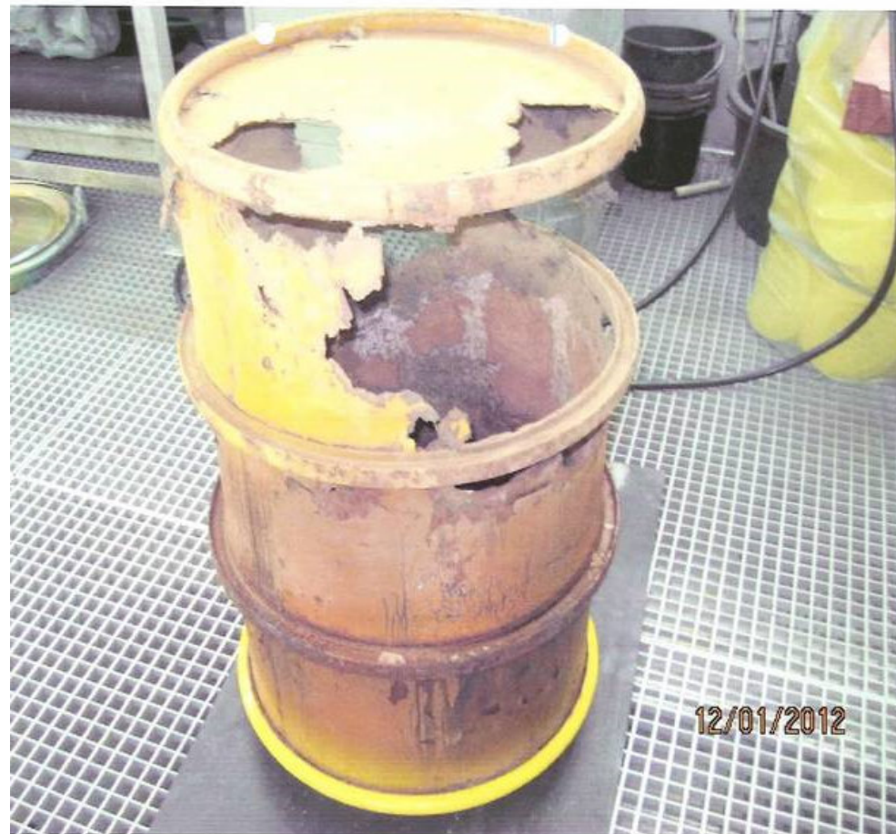
Rostfass Kaverne Brunsbüttel
