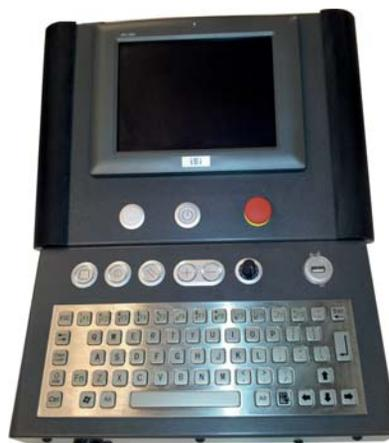
Externe CNC-Steuerung Fabrikat NUM (Schweiz) mit LCD-Bildschirm zur ISO-Programmierung, Werkzeugkorrektur, Speicher für Werkstückprogramme, Standard-Schnittstelle
