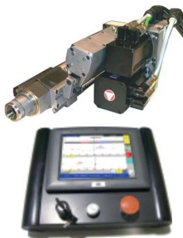
Der elektronischen Stellantrieb besteht im wesentlichen aus ein Servo-Motor mit Encoder, Kugelrollspindel, Computer mit kleinen Touch-Screen und eine Software zur Erzeugung und Speicherung von Kurven die unter Windows läuft.
