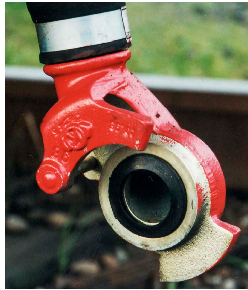
Abb. 3-10: Dichtungsring im Kupplungskopf Fotos: Jürgen Janicki
