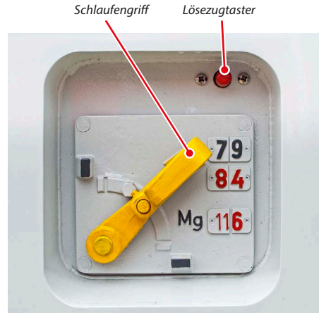
Abb. 3-5: Bremsstellungswechsel eines Reisezugwagens eingestellt in „R“
