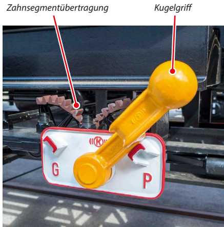
Abb. 3-4: Bremsstellungswechsel eines Güterwagens eingestellt in „P“
