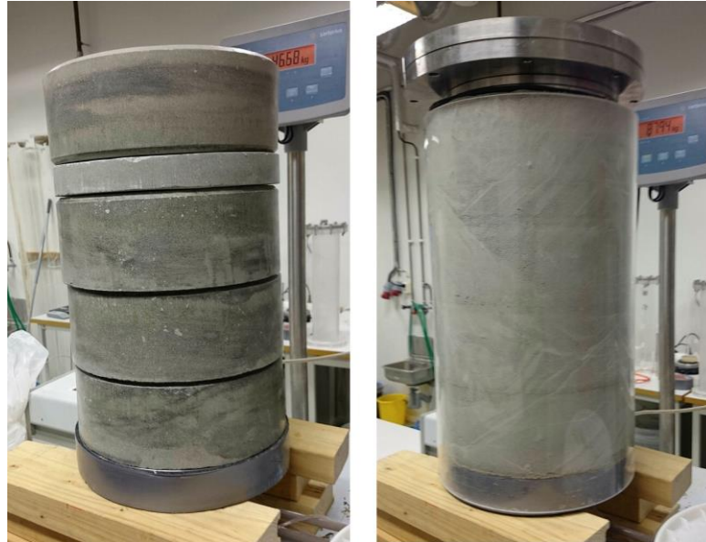
Abbildung 3-2. Fotografien von dem Versuchsaufbau, bei dem eine Kupferheizung von vier Bentonitringen eingeschlossen und dann von einem massiven Bentonitblock bedeckt wird.
