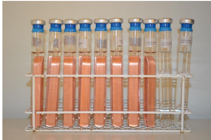
Abbildung 4-2. Versiegelte Reagenzröhrchen mit Kupfer in reinem, sauerstofffreiem Wasser. Die 6 cm 3 große Gastasche oben in den Reagenzröhrchen wird regelmäßig beprobt. Zwei der Röhrchen enthalten nur Wasser und Gas. Das Bild wurde aufgenommen, als das Kupfer 27 Monate lang reinem, sauerstofffreiem Wasser bei 70 °C ausgesetzt worden war.
