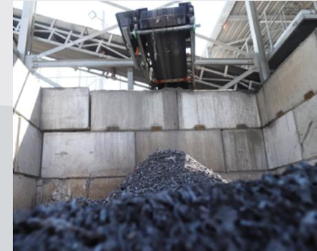
Während kräftige Magnete das Eisen entfernen, blasen zwei Ventilatoren – die sogenannten Windsichter – die leichten, noch nicht vollständig verbrannten Teile aus der Schlacke heraus. Im hinteren Bereich der Anlage baut ein Wirbelstromscheider ein sehr starkes Magnetfeld auf. Aluminium- und Kupferpartikel oder andere Metalle laden sich darin elektrisch auf, was zu einer Abstossung führt. Sie fliegen am Ende des Förderbands weg. Die Schlackekörner hingegen fallen energielos herunter.
