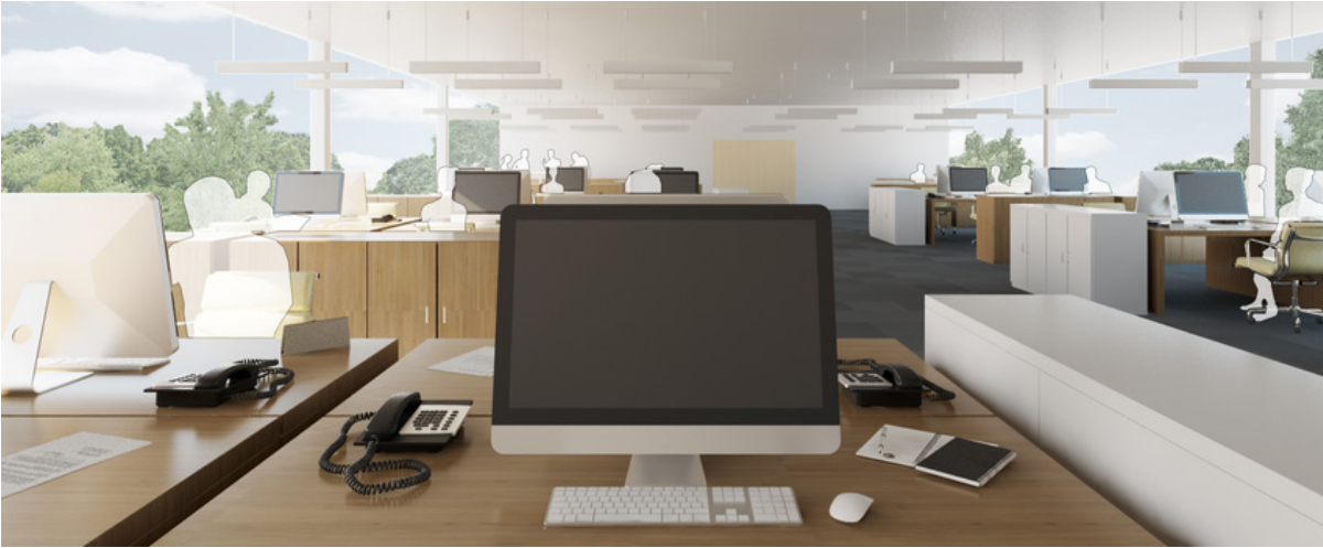
3D-Ansicht: Ohne Glasabtrennung sowie ohne Sideboard ( L_{pAeq} = 52.0 dB)
