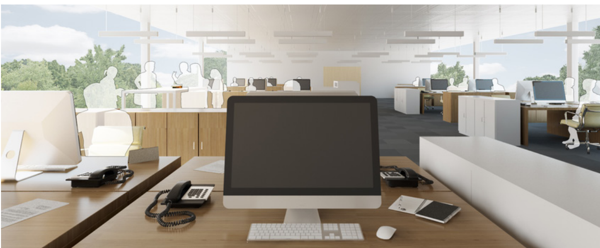
3D-Ansicht: Ungünstige Anordnung der Arbeitsplätze mit absorbierender Decke ( L_{pAeq} = 59.9 dB)
