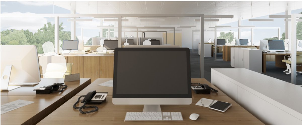
3D-Ansicht: Glasabtrennung zwei Meter hoch mit Zwischenraum zur Fensterfront jedoch ohne absorbierende Büromöbel und Wände ( L_{pAeq} = 49.3 dB)
