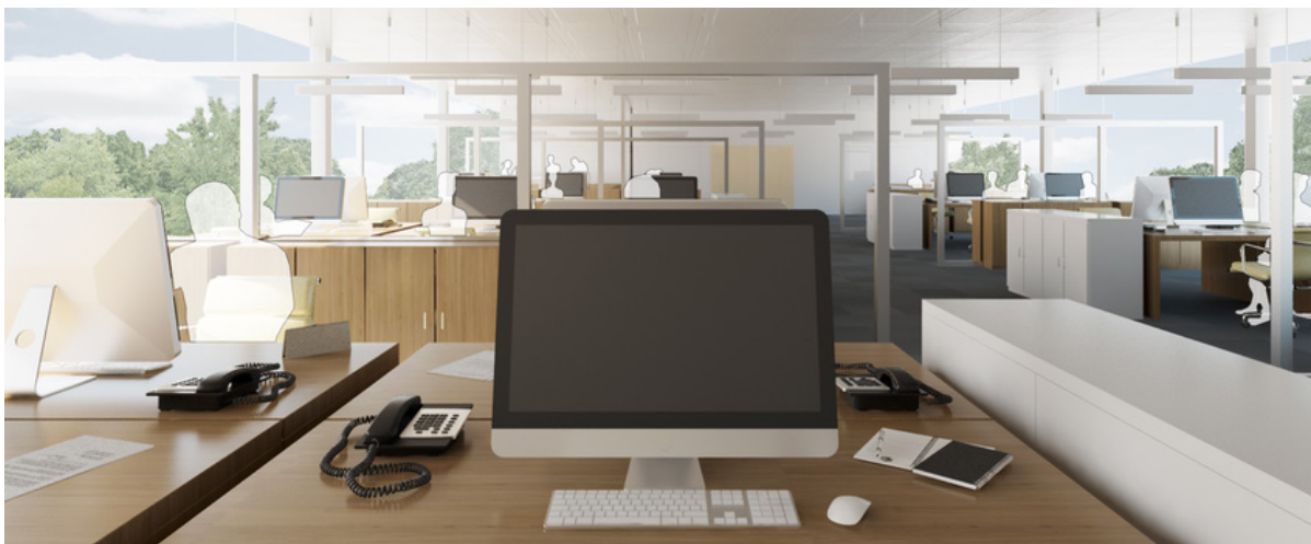
3D-Ansicht: Mit absorbierender Decke sowie mit Glasabtrennung ( L_{pAeq} = 53.8 \text{ dB} )
