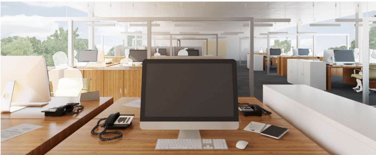
3D-Ansicht: Glasabtrennung zwei Meter hoch mit Zwischenraum zur Fensterfront sowie absorbierenden Möbeln und Wänden ( L_{pAeq} = 47.6 dB)
