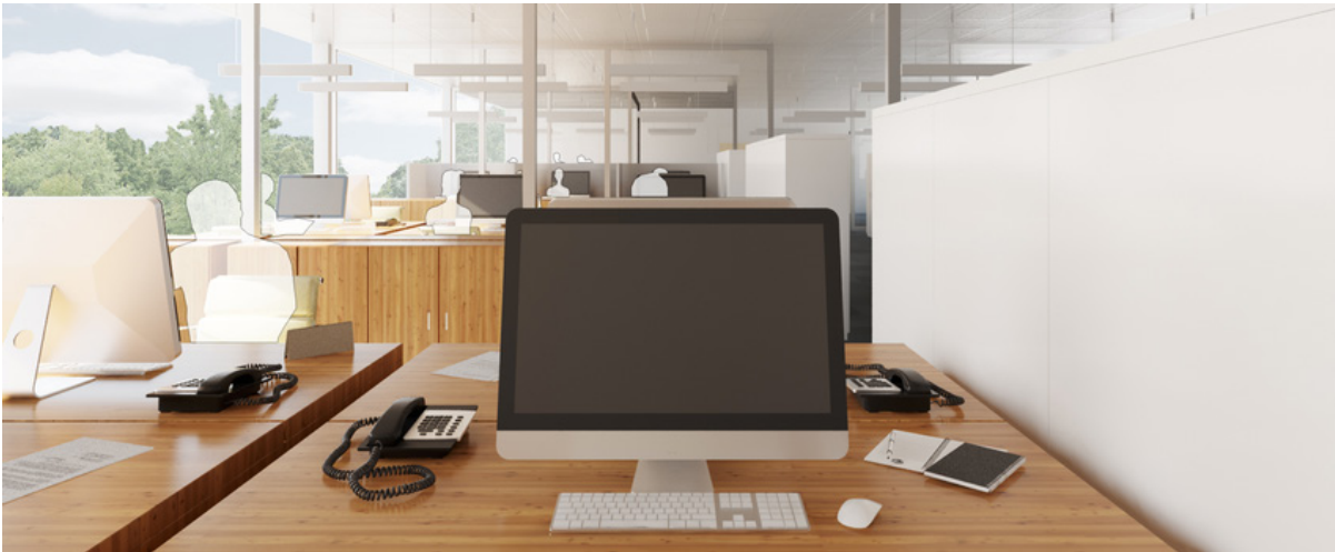
3D-Ansicht: Mit absorbierenden Möbeln sowie mit Sideboard zum Gang ( L_{pAeq} = 45.9 dB)
