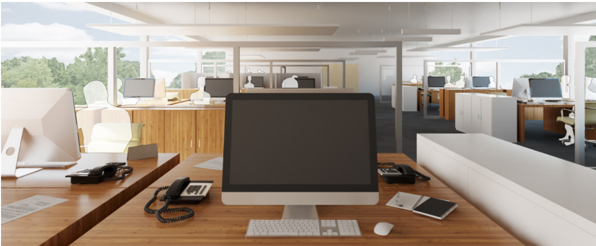
3D-Ansicht: Mit absorbierenden Büromöbeln und Wänden sowie mit Glasabtrennung ( L_{pAeq} = 47.7 dB)
