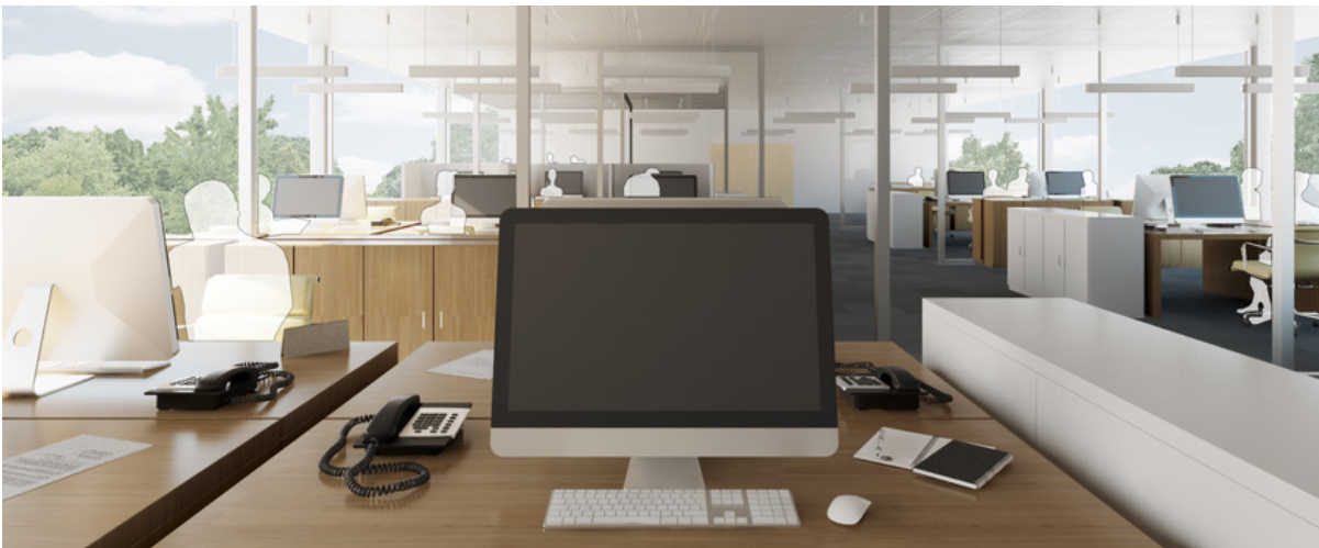
3D-Ansicht: Ohne absorbierende Möbel und Wände sowie ohne Sideboard zum Gang ( L_{pAeq} = 48.5 dB)
