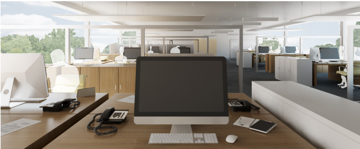
3D-Ansicht: Ohne absorbierende Büromöbel und Wände, jedoch mit Glasabtrennung ( L_{pAeq} = 50.4 \text{ dB} )
