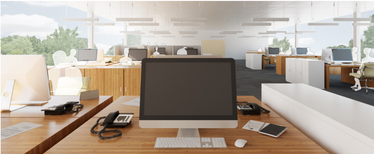
3D-Ansicht: Mit absorbierenden Büromöbeln, jedoch ohne absorbierende Wände ( L_{pAeq} = 49.5 dB)
