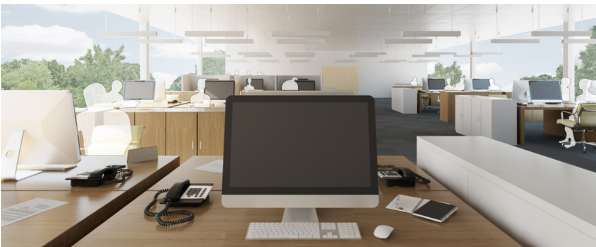
3D-Ansicht: Ohne Glasabtrennung sowie ohne absorbierende Büromöbel und Wände ( L_{pAeq} = 50.1 dB)
