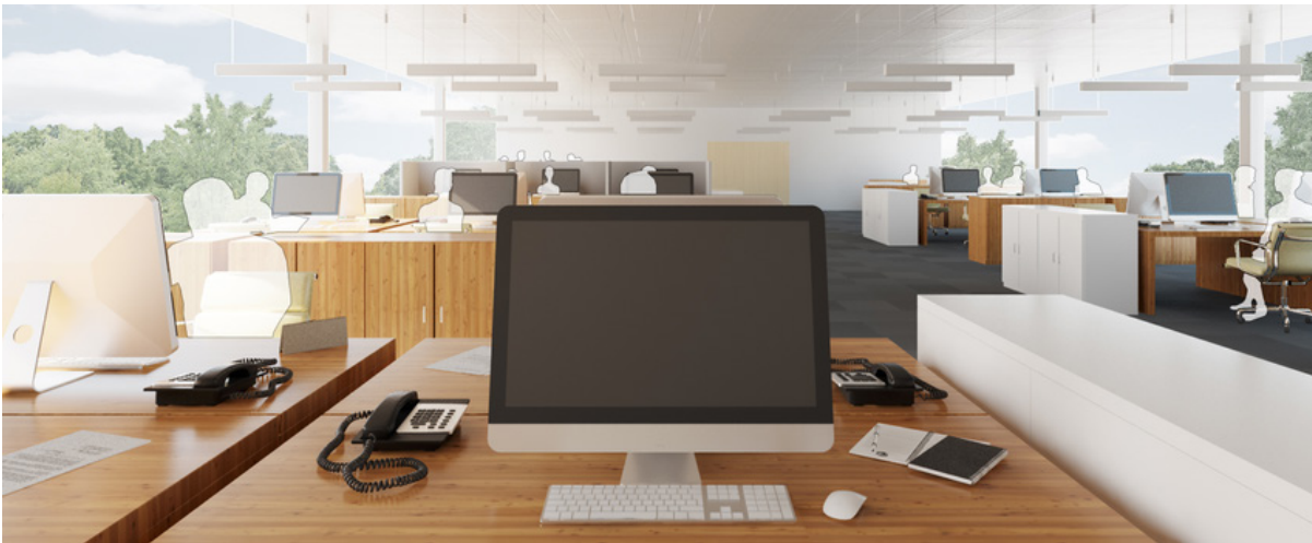
3D-Ansicht: Mit absorbierenden Büromöbeln und Wänden ( L_{pAeq} = 48.7 dB)
