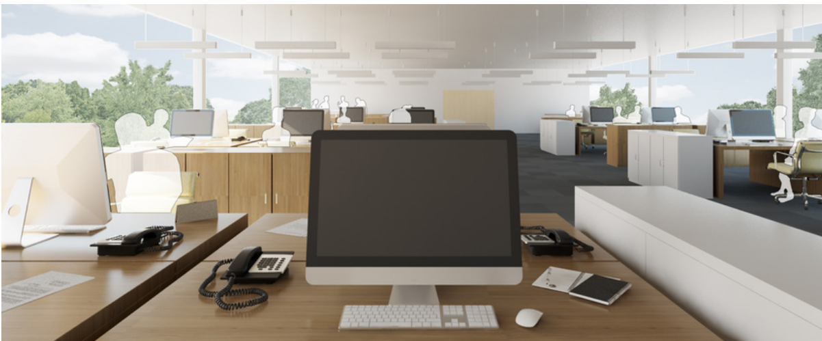
3D-Ansicht: Günstige Anordnung der Arbeitsplätze ohne absorbierende Decke ( L_{pAeq} = 56.3 dB)
