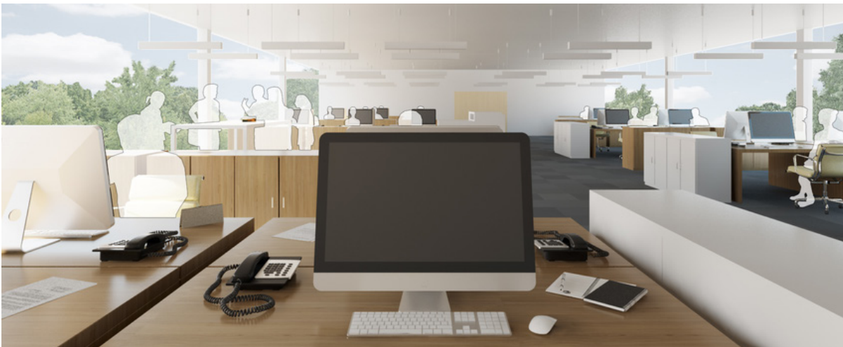
3D-Ansicht: Ungünstige Anordnung der Arbeitsplätze ohne absorbierende Decke ( L_{pAeq} = 62.4 dB)
