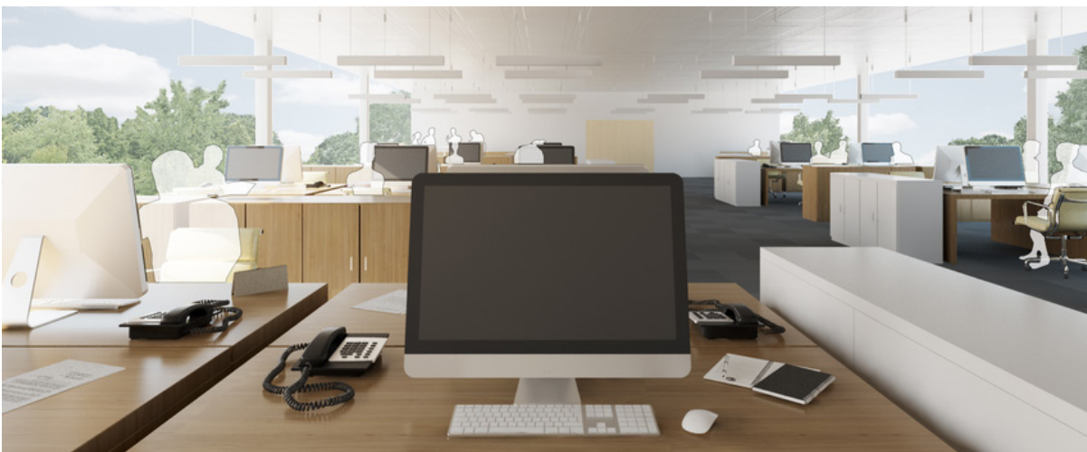
3D-Ansicht: Günstige Anordnung der Arbeitsplätze mit absorbierender Decke ( L_{pAeq} = 52.0 dB)
