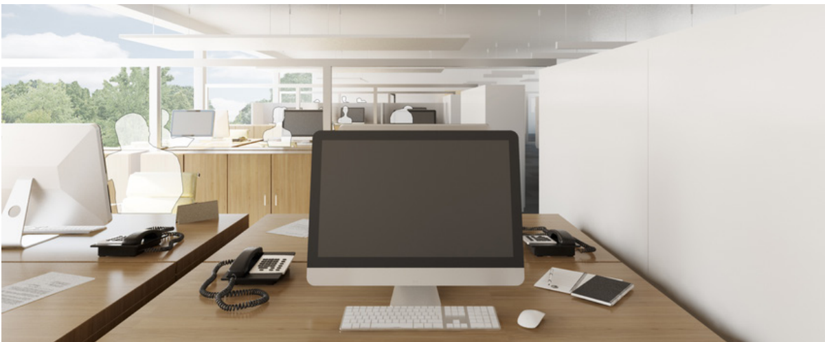
3D-Ansicht: Ohne absorbierende Büromöbel und Wände, jedoch mit Glasabtrennung und erhöhten Sideboards zum Gang ( L_{pAeq} = 49.6 dB)
