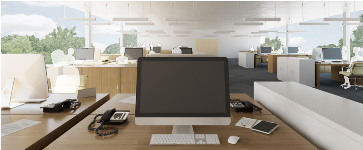
3D-Ansicht: Mit absorbierender Decke, jedoch ohne Glasabtrennung ( L_{pAeq} = 52.0 dB)
