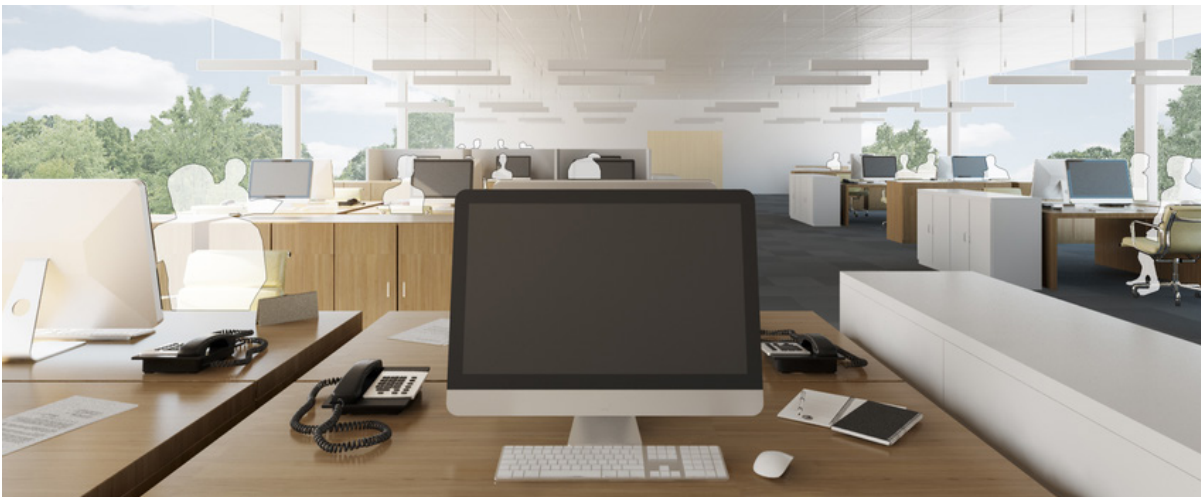
3D-Ansicht: Mit absorbierenden Wänden, jedoch ohne absorbierende Büromöbel ( L_{pAeq} = 49.2 \text{ dB} )
