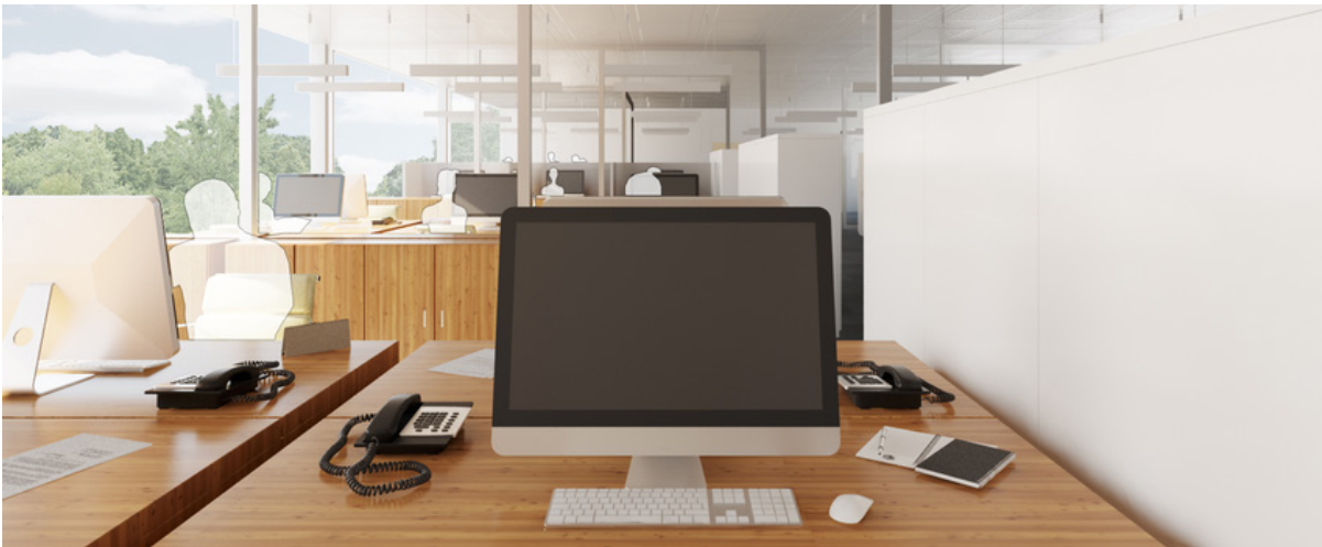
3D-Ansicht: Mit absorbierenden Möbeln und Wänden sowie mit Sideboard zum Gang ( L_{pAeq} = 43.8 dB)
