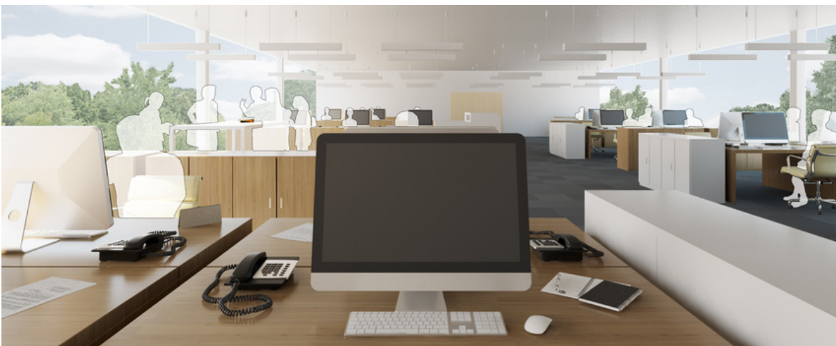
3D-Ansicht: Schlechteste Situation - ungünstige Anordnung der Arbeitsplätze ohne absorbierende Decke ( L_{pAeq} = 62.4 dB)
