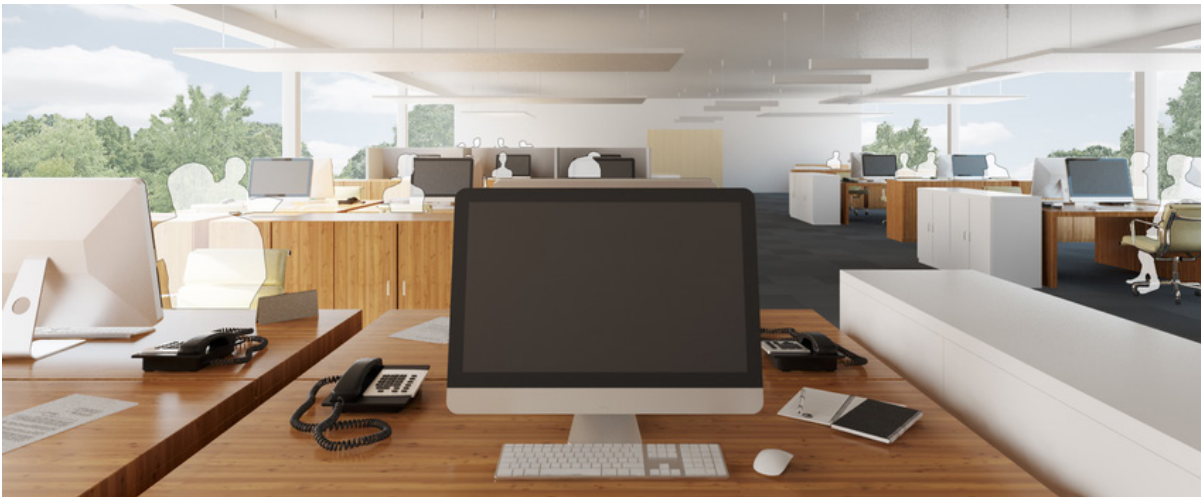
3D-Ansicht: Mit absorbierenden Büromöbeln und Wänden ( L_{pAeq} = 49.2 dB)
