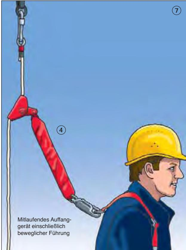
Mitlaufendes Auffanggerät einschließlich beweglicher Führung
