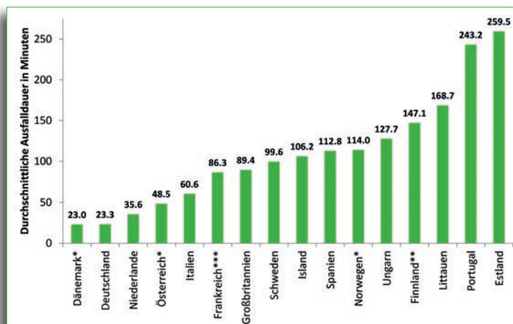
Abb. 1: Durchschnittliche Stromausfalldauer in Minuten in 2006 je Abnehmer in allen Spannungsebenen. Ausnahmen sind *ohne Niederspannung, **ohne Hoch- und Niederspannung, ***ohne Hoch- und Mittelspannung. 2
