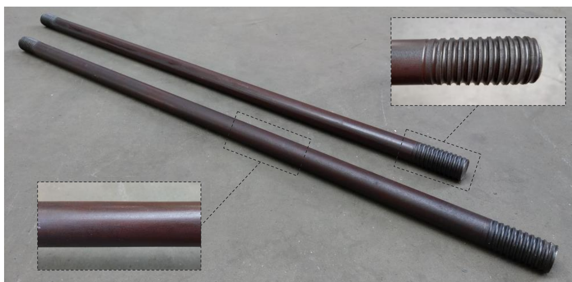
Bild 1: Glatter Spannstahl der Güte St 835/1030 bzw. Y1030H und Ermüdungsfestigkeitsklasse 1 mit aufgerolltem Gewinde an den Stabenden
