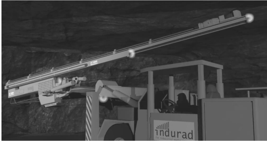
Abbildung 2: Installation der iRTT-AntennaUnits entlang der Bohrlafette
