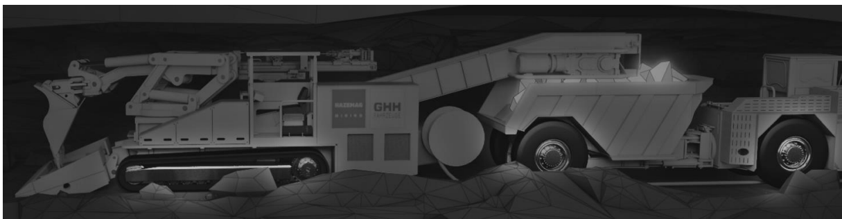
Abbildung 1: HRE - Beladesituation mit Dumper
