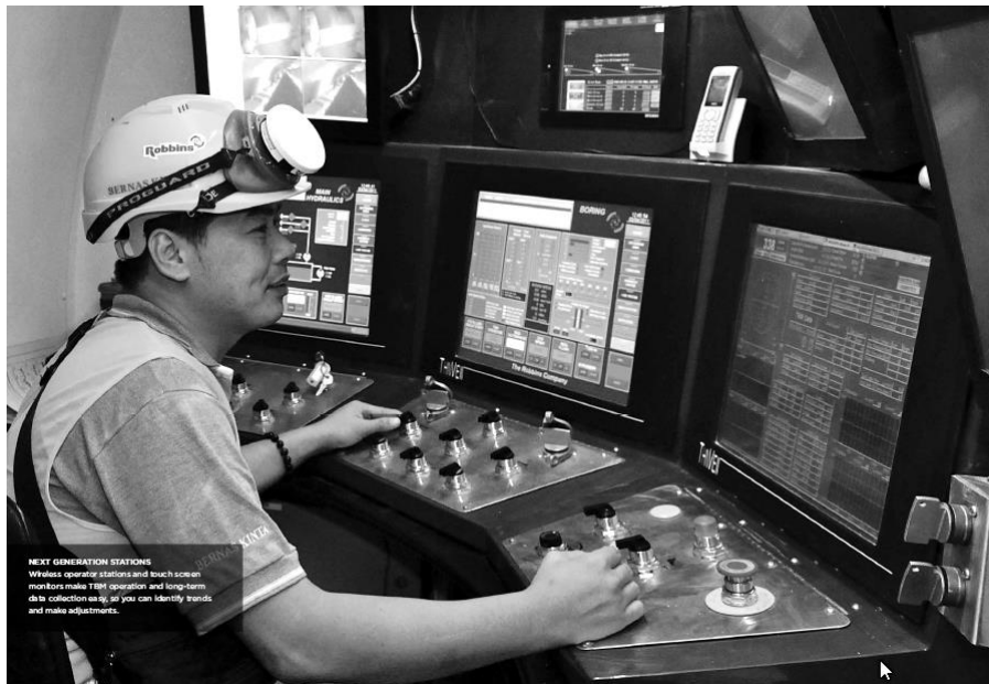
Abbildung 5: Steuerstand einer TBM, Quelle: The Robbins Company
