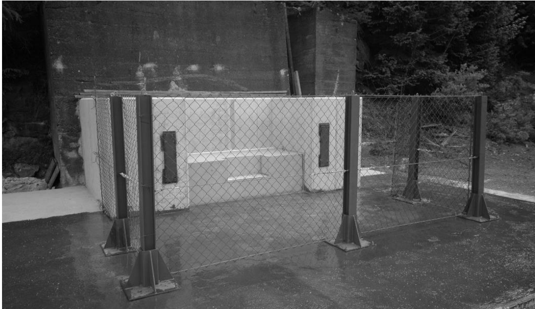
Abbildung 1: Versuchseinrichtung am Erzberg, die durch ihren Aufbau die Wellen von der Probe entweichen lässt. Die innere Aufnahme hat die genauen Maße des Probenkörpers.
