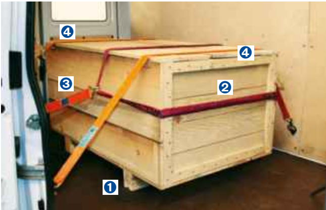
Prinzipzeichnung einer kombinierten Ladungssicherung (Kopfschlinge / Niederzurren)
