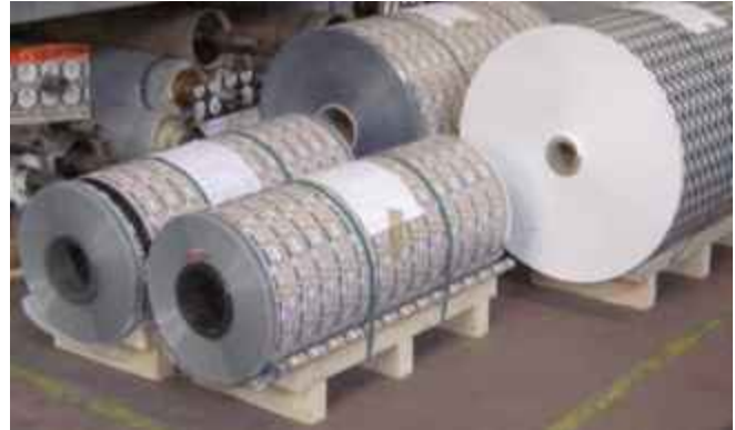
Schwere Rollenware mit empfindlicher Oberfläche mit Kunststoffbändern gesichert
