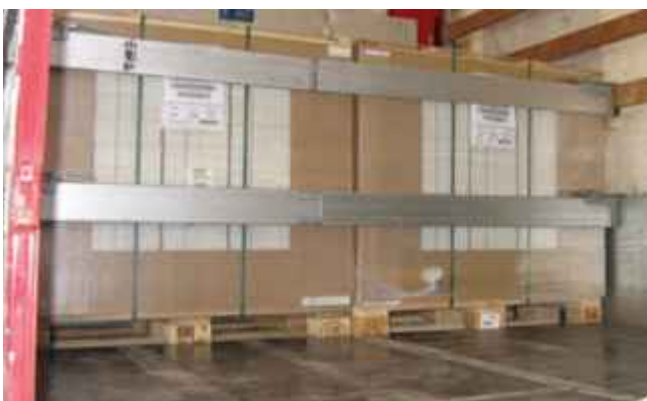
Beispiel für eine formschlüssige Beladung auf einem Lkw mit Hamburger Verdeck nach vorn und zur Seite. Für die rückwärtige Sicherung gegen Kippen werden zwei Klemmbretter eingesetzt.
