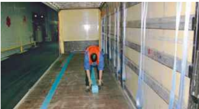
Ausrollen des rutschhemmenden Materials
