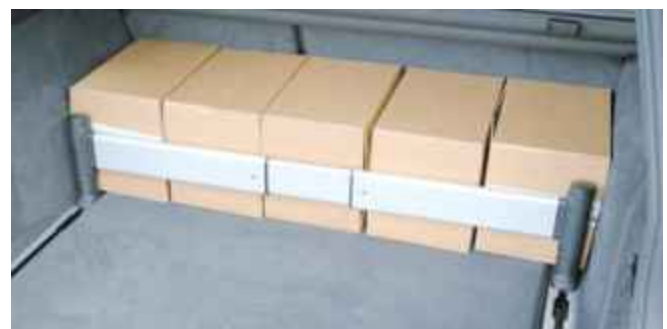
Schienensystem im Gepäckraum für Teleskopstangen
