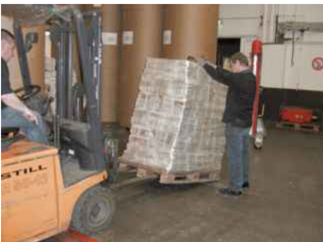
Missglückter Kippversuch (V1, Gewicht 704\text{ kg} ); Fußwicklung bei 15^\circ gerissen; Ladeeinheitensicherung ungeeignet
