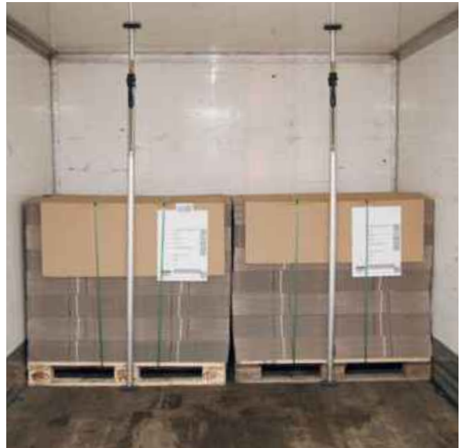
Klemmstangen zum rückwärtigen Fixieren gegen Kippen
