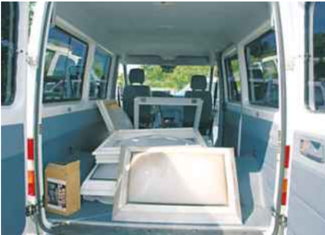
Diese Dachluken können die Fahrzeuginsassen verletzen.
