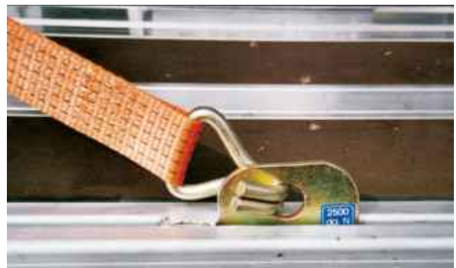
Rungentaschenreihe mit Zurrloch; Belastung Zurrlöcher 2.000 daN
