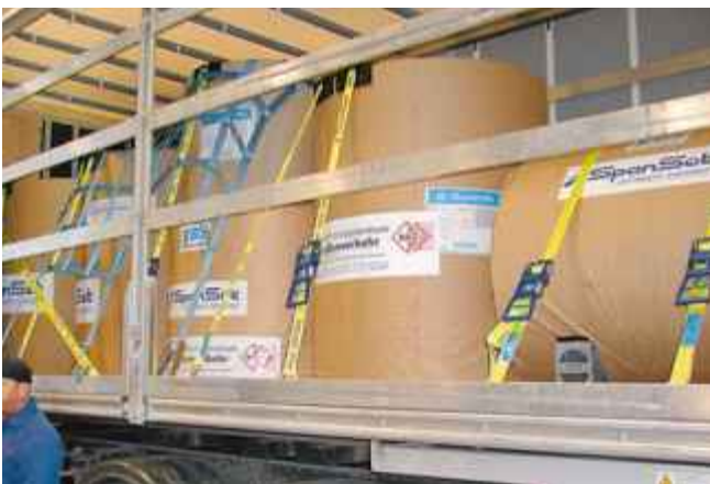
Kombination aus Zurrgurten und -netzen
