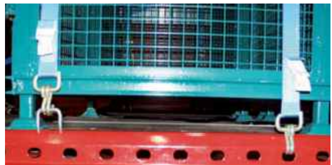
Durch variable Zurrpunktsysteme können schwere Einzellasten ent- sprechend dem Lastverteilungsplan punktgenau platziert und gesichert werden.
