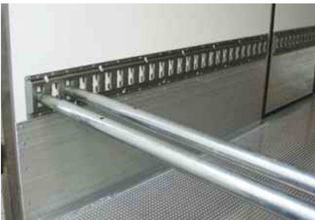
Ankerschiene mit Sperrstangen
