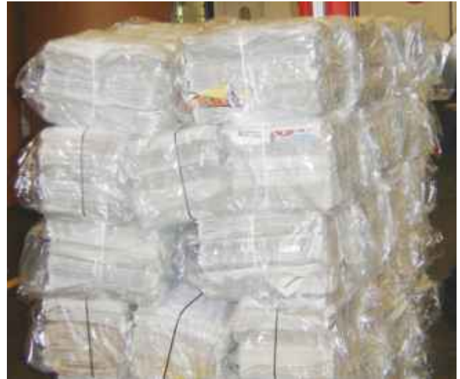
Zeitungspakete auf Palette sind komprimierbar und alleine durch Niederzurren nicht zu sichern.
