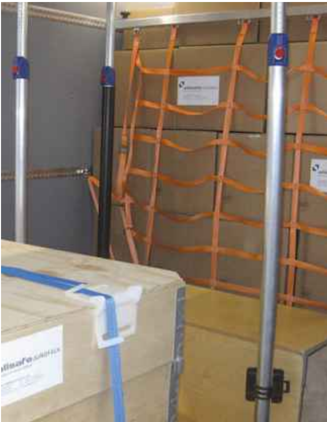
Blockieren mit Hilfe von Sperrstangen
