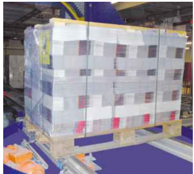
Palette mit Kopfplatte, Umreifung und horizontaler Folienstretchung
