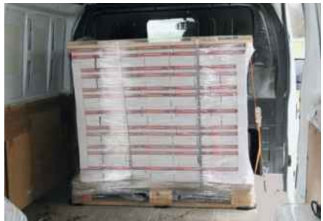
Ansicht von hinten: Der Zurrkord verläuft etwa im Winkel von 90°, wodurch annähernd die gesamte Vorspannkraft des Zurrmittels in das Ladegut eingeleitet wird. Da die Bücherpalette einer ordnungsgemäßen transportfähigen Ladeeinheit entspricht, ist die Ladungssicherung entsprechend der technischen Normen möglich.
