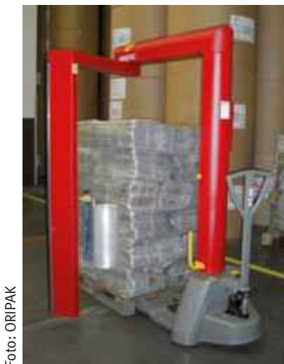
Mobiler, netzunabhängiger Hubwagen-Dreharmwickler
