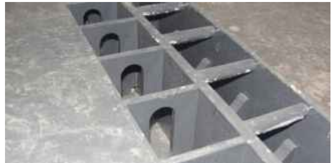
Rungentaschenreihe mit Zurrloch; Belastung Zurrlöcher 2.000 daN
