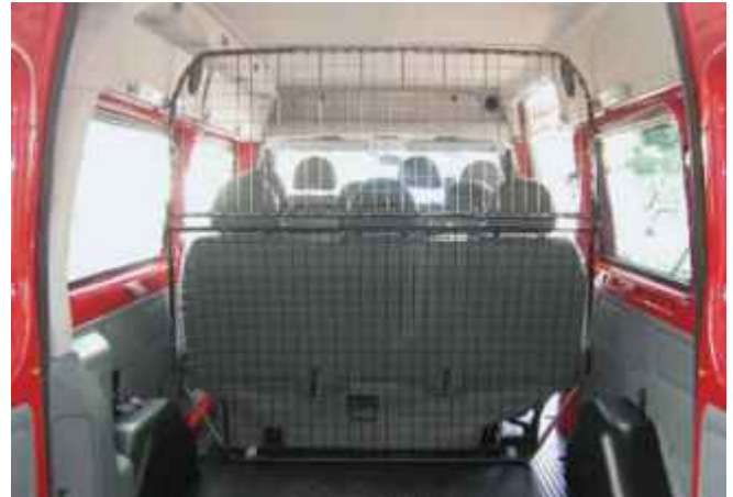
Nachträglich eingebautes Trenngitter in einem Transporter
