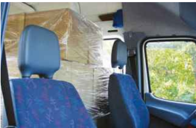
Diese ungesicherte Ladung kann für den Fahrer lebensgefährlich werden.
