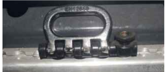
Zurrschienensystem mit Rasterabstand
