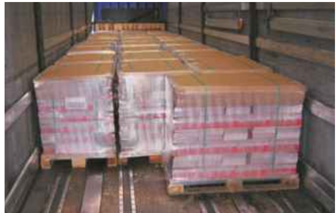
Kombination: Stülphaube aus Pappe, Umreifung, horizontale Folienstretzung
