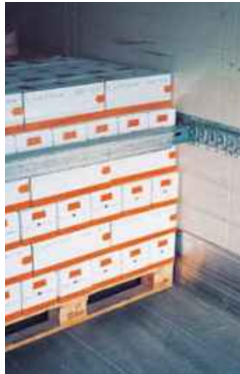
Ankerschiene mit Sperrbalken im Transporter
