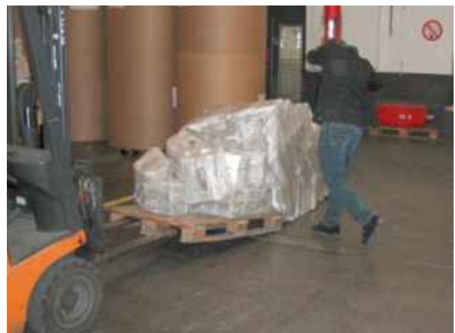
Missglückter Kippversuch (V1, Gewicht 704\text{ kg} ); Fußwicklung bei 15^\circ gerissen; Ladeeinheitensicherung ungeeignet
