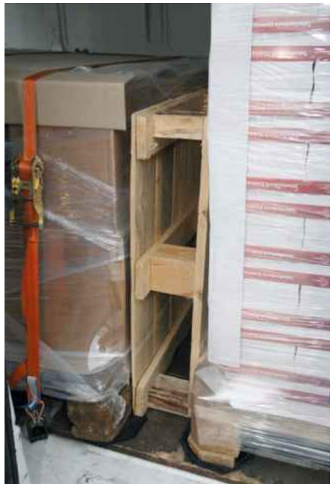
Aufgrund des überstehenden Kopfdeckels der hinteren Palette ist kein direkter Formschluss zur vorderen Palette möglich. Die Ladelücke wurde mit einer Einwegpalette und einer Holzplatte geschlossen. Beide liegen vollflächig am Ladegut an und verhindern dadurch die Beschädigung der Ware bei einer Vollbremsung.
