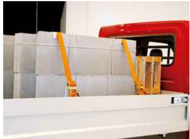
Praxisbeispiel: Leerpaletten als Hilfsmittel zum Herstellen des Formschlusses in Fahrtrichtung in Kombination mit Niederzurren
