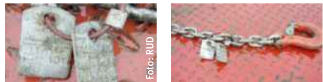
Diese Ketten haben einen zweiten Anhänger mit dem Prüfdatum.
