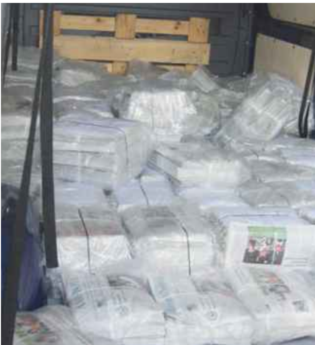
Verteilung der Zeitungspakete nach dem Fahrversuch
