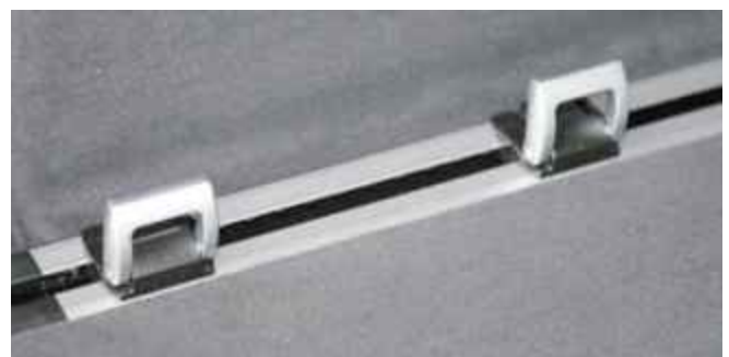
Variable Zurrpunkte im Schienensystem
