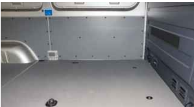
Beispiele für Zurrpunkte in einem Kastenwagen
