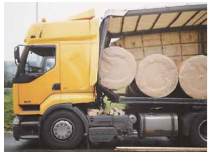
Eine ungesicherte Ladung wird beim Fahren ins Rutschen, Rollen oder ins Kippen geraten, wenn die Sicherungskraft nicht ausreichend ist.
