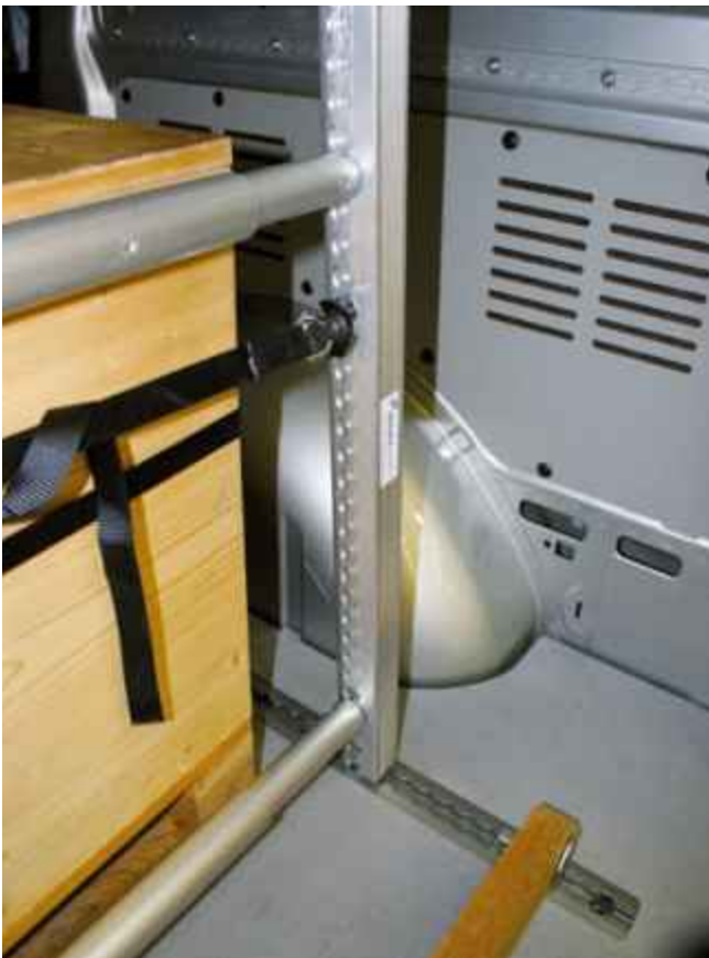
Lochschiene mit Vorrichtung für Sperrstangen
