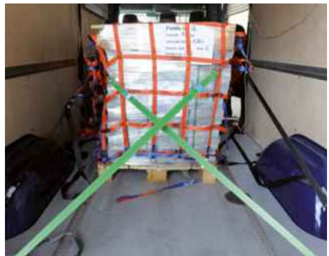
unten: Sicherung durch Zurrnetz
