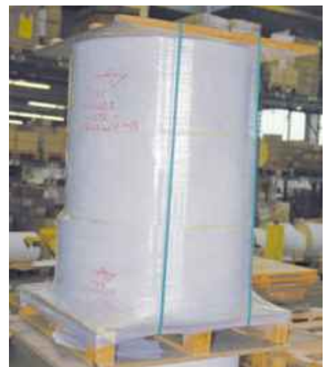
Kombination: Abdeckplatte, Umreifung, Folienstretzung
