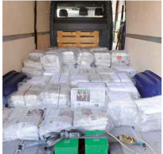
Zeitungs pakete gleichmäßig auf der Ladefläche verteilt. Bild rechts: Im Vordergrund die beiden Sensoren zur Aufnahme der Verzögerungswerte.
