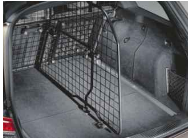
Kombinierbare Stahlgitter (Raumteilung/Schutz des Fahrgastraums)
