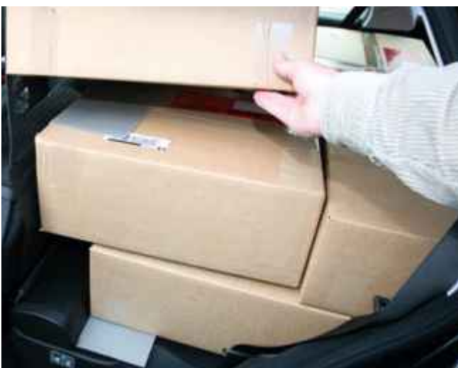
Rutschhemmende Vollpappe als Zwischenlage
