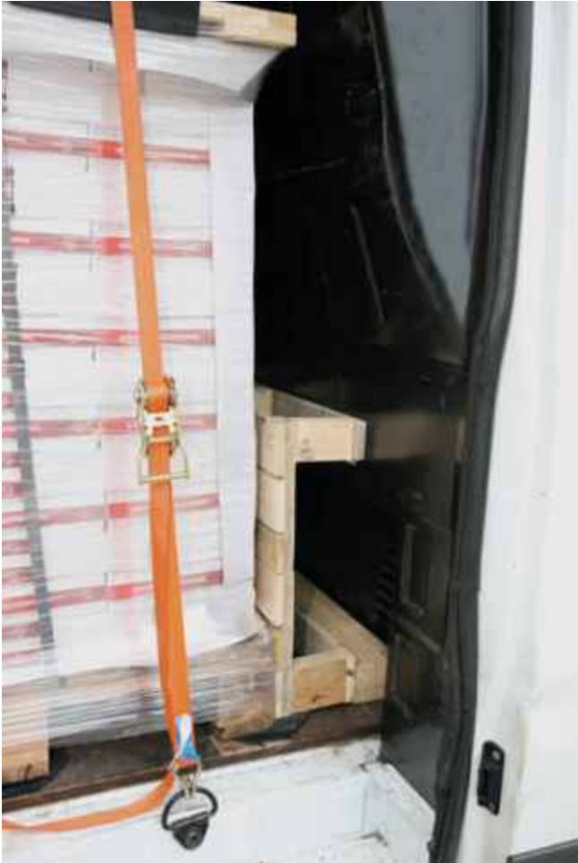
Ausfüllen der Ladelücke zur Stirnwand mit Palette und Holzbalken
