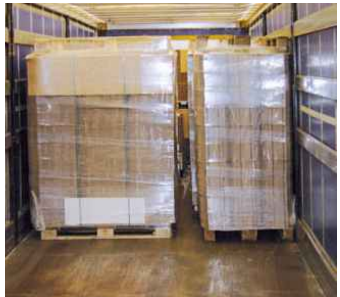
Diese Ladelücken sind zu groß, sie müssen ausgefüllt werden.
