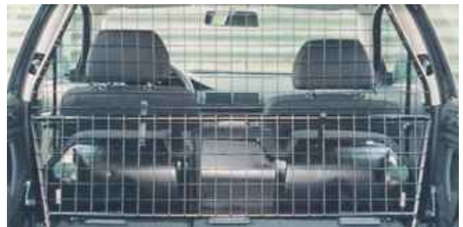
Nachträglich eingebautes Trenngitter nach DIN 75410-2
