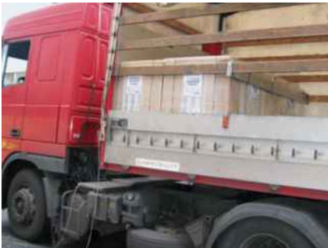
Diese Ladelücken sind zu groß, sie müssen ausgefüllt werden.
