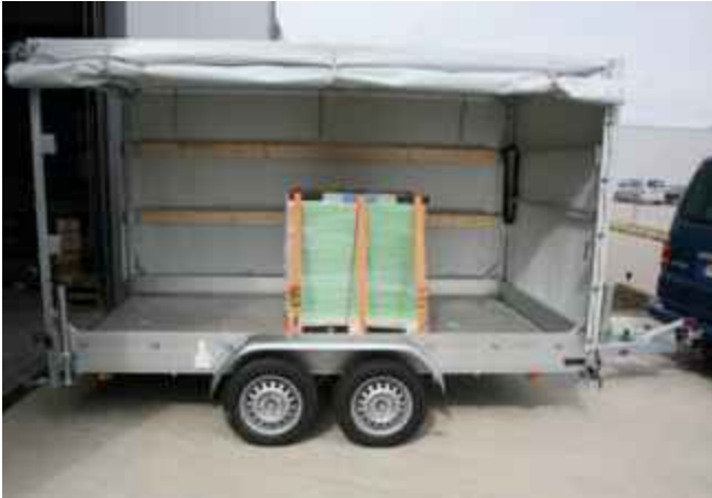
Ordnungsgemäße Lastverteilung auf einem Anhänger
