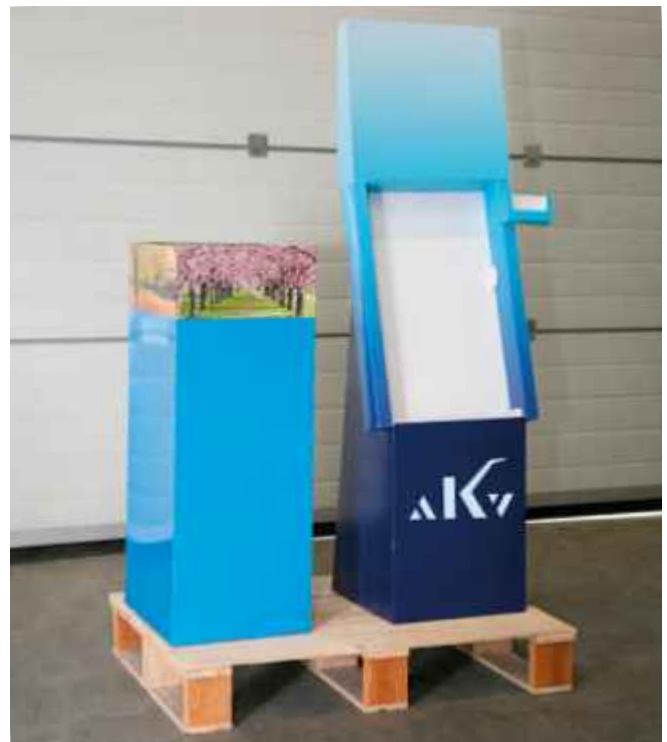
Displays sind nicht formstabil und würden beim Niederzurren beschädigt werden.
