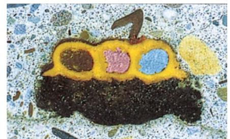
Schnitt durch die injizierte Fuge nach mehrfacher Verpressung.
