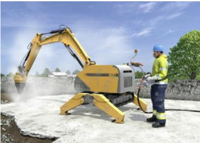
Abb. 83 Ferngesteuerte Abbruchmaschine
