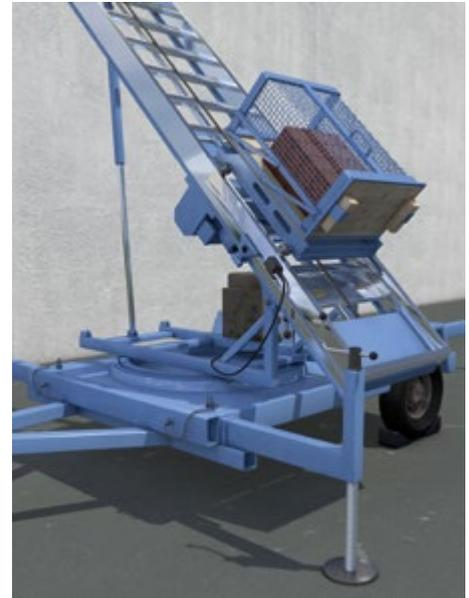
Abb. 73 Mobiler Lastenaufzug
