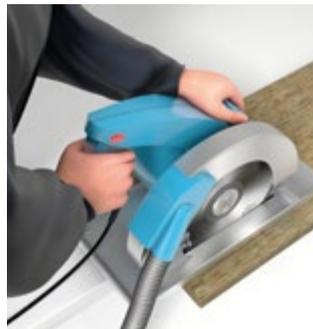
Abb. 62 Handkreissäge
