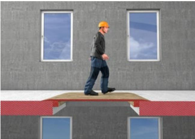
Abb. 3 Sicherung von Deckenöffnungen (Schnittdarstellung)
