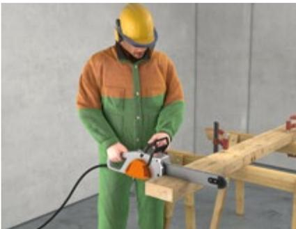
Abb. 61 Elektrische Handkettensäge
