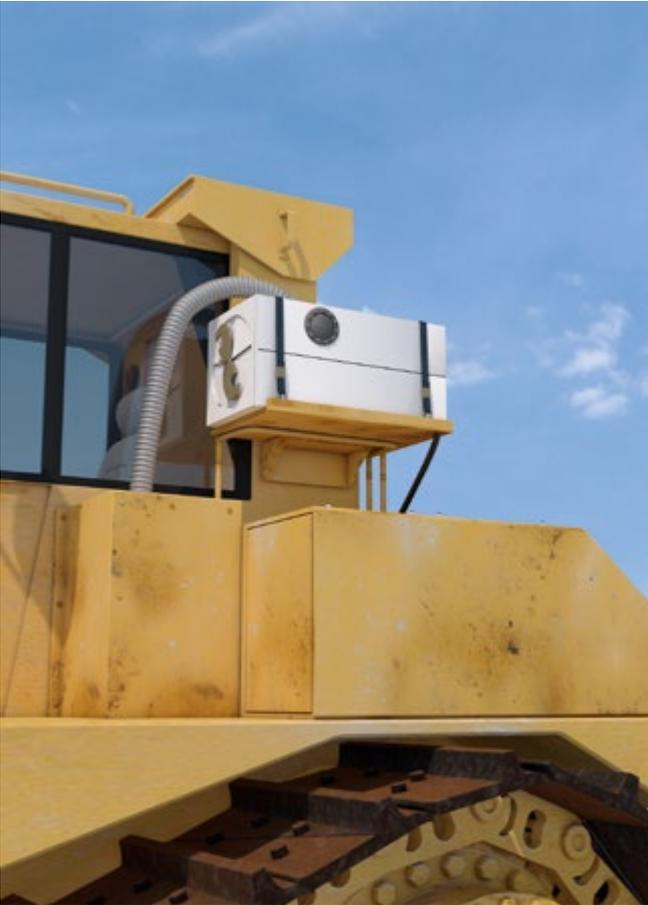
Abb. 15 Filteranlage zur Atemluftversorgung des Geräteführers
