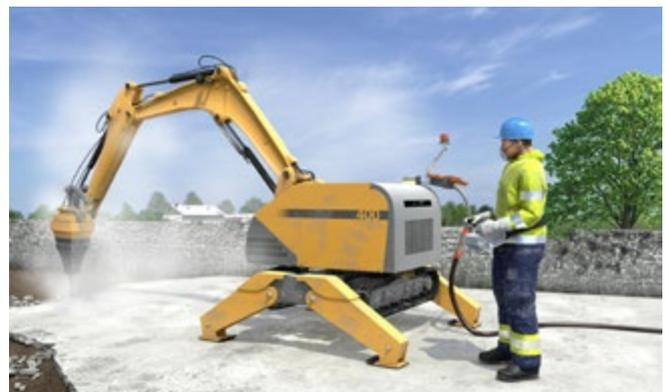
Abb. 102 ferngesteuerte Abbruchmaschine statt handgeführte Werkzeuge
