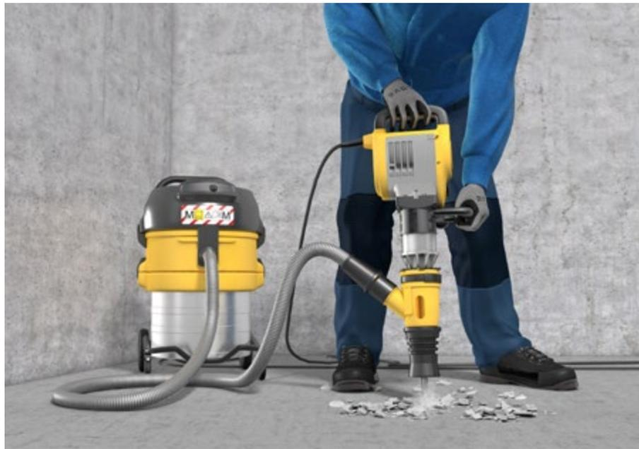
Abb. 100 Abbruchhammer mit Absaugung
