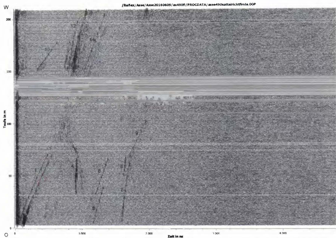
Abb. 9: Radargramm mit markierten Reflektoren an der Firste der Sattelrichtstrecke auf der 490-m-Sohle, 70-MHz-Antenne geschirmt.
