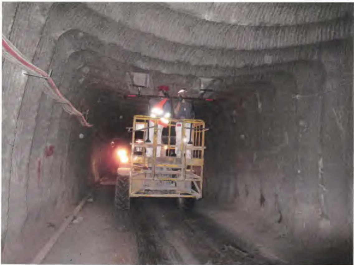
Abb. 1: Durchführung der EMR-Messung mit geschirmten 70-MHz-Antennen an der Firste der Abbau-begleitschneise auf der 511-m-Sohle.
