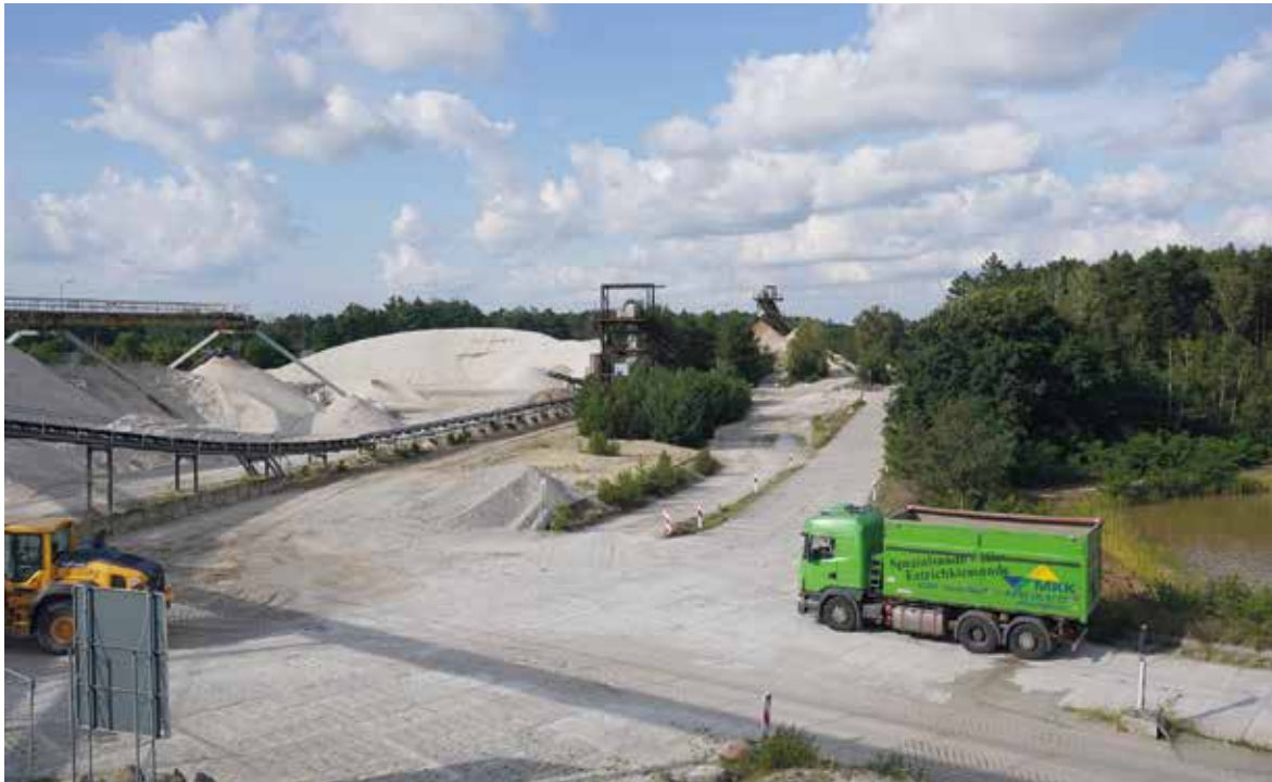
Über ein Förderband erreicht der Kiessand die Aufbereitungsanlage der MKK Märkische Kies- und Kalksandsteinwerke GmbH, wo daraus alle gängigen gewaschenen Sand- und Kiessorten sowie 20 verschiedene Trockensandsorten produziert werden, Foto: BGR.
