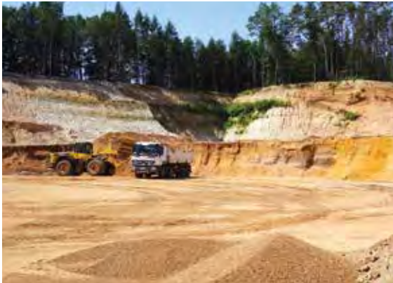
In der Sandgrube Röttenbach-Mühlstetten werden hochwertige quarzreiche Sande abgebaut, die nach Wäsche in bis zu 70 km Entfernung vor allem als Betonsande Verwendung finden, Foto: BGR.
