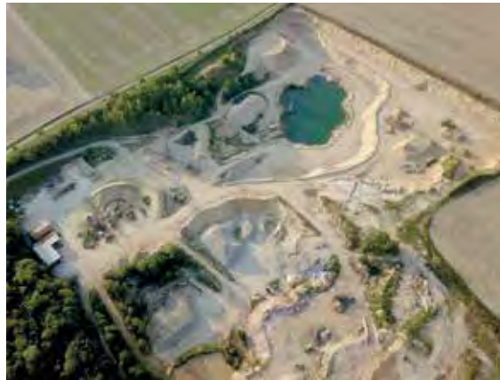
Luftaufnahme des KW Ludwigsdorf mit seinen Teilverfüllungs- und Nassauskiesungsbereichen, Foto: Kuhn Kies + Sand GmbH (mit frdl. Genehmigung).
