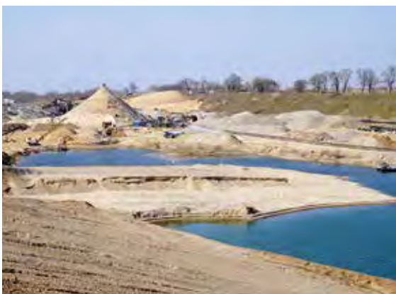
Im Abbaufeld Krassow-Süd des KW Krassow der Otto Dörner Kies und Umwelt Mecklenburg GmbH & Co. KG werden die sowohl im Trockenen als auch im Nassen gewonnenen Rohkiessande zu vielfältigen Produkten für die regionale Bauwirtschaft aufbereitet, Foto: BGR.
