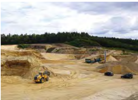
Blick in die Kiessandgrube Wagenfeld der Wiechert GmbH. Diese liegt in der Strauchendmoräne des Kellenbergs, wo bis zu 5 m mächtige Linsen von Beckenschluffen und Geschiebelehm in Schmelzwassersande und -kiessande eingeschuppt wurden, Foto. BGR.
