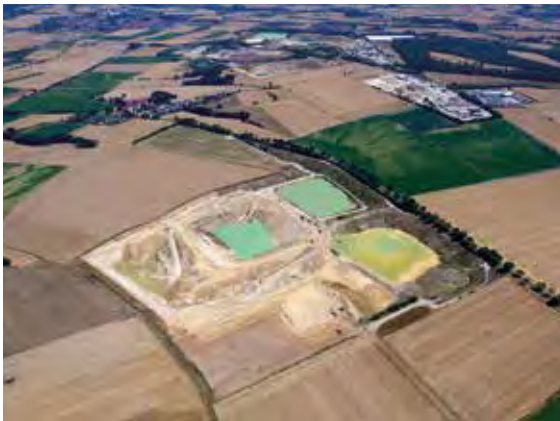
Luftaufnahme des Kiessandabbaus Großenegler Platte mit seinen großen Schlammteichen im Vordergrund und des KW Wabern-Udenborn im Hintergrund, Foto: KIMM GmbH & Co. KG (mit frdl. Genehmigung).
