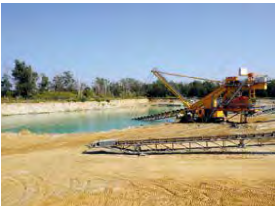
Im KW Otterwisch der Betonwerk Bad Lausick GmbH & Co. KG ist seit wenigen Jahren ein neuer, landgestützter Eimerkettenbagger in Betrieb, Foto: BGR.
