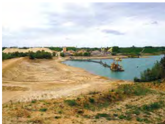
Im KW Negenborn der GP Günter Papenburg AG werden die Kiessande des Stauchendmoränenzugs der Brelinger Berge sowohl im Trockenen, als auch in einem zweiten Abbauschritt im Nassen mittels Schwimmgreifer abgebaut, Foto: BGR.
