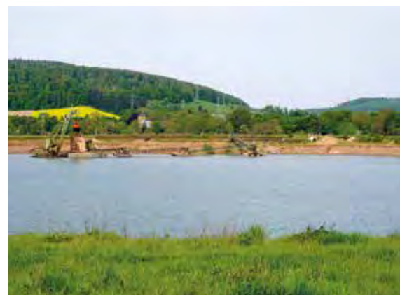
In einigen Bereichen erreichen die Kiessandmächtigkeiten bei Höxter-Lüchtringen 22 m, so dass im dortigen Union Weserkieswerk ein Schwimmgreifer zur Gewinnung im Einsatz ist, Foto: BGR.
