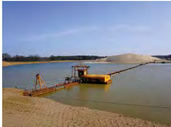
Im Abbaufeld Zweedorf II Nord erfolgt die Gewinnung mittels Saugbagger. Der in großen Mengen aus dem Rohkiessand abgetrennte Feinsand (Hintergrund) wird vorerst aufgehaldet bzw. dient zur Verfüllung des Baggersees, Foto: BGR.
