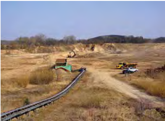
Im nördlichen Abbaufeld des KW Pinnowhof werden noch Restmengen im Trockenbau abgebaut, dann erfolgt auch hier der Übergang in den Nassabbau, Foto: BGR.
