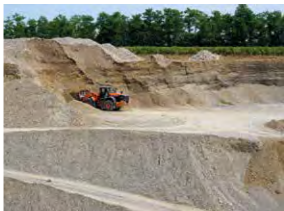
Die REHM Kies- & Betonwerk GmbH & Co. KG baut Wandkies ab, der nach Aufbereitung fast vollständig als Gesteinskörnungen in der Transportbetonproduktion zum Einsatz kommt, Foto: BGR.
