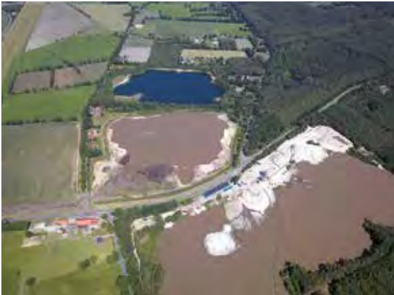
Das KW Bohlenbergerfeld im Luftbild mit Altsee im Süden und derzeit ausgesandetem See im Norden. Noch weiter nördlich (dunkelblau) eine weitere, längst renaturalisierte Altaussandung, Foto: Kiesgrube Bohlenbergerfeld GmbH & Co. KG (mit frdl. Genehmigung).
