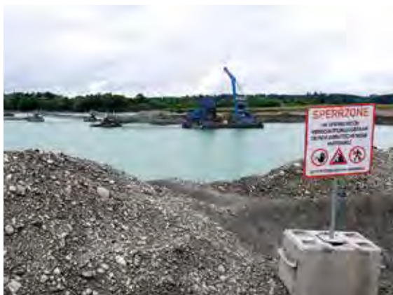
Die Schussen - Kieswerk Rieger GmbH & Co. KG betreibt eine der wenigen Nassauskiesungen im nördlichen Oberschwaben, Foto: BGR.
