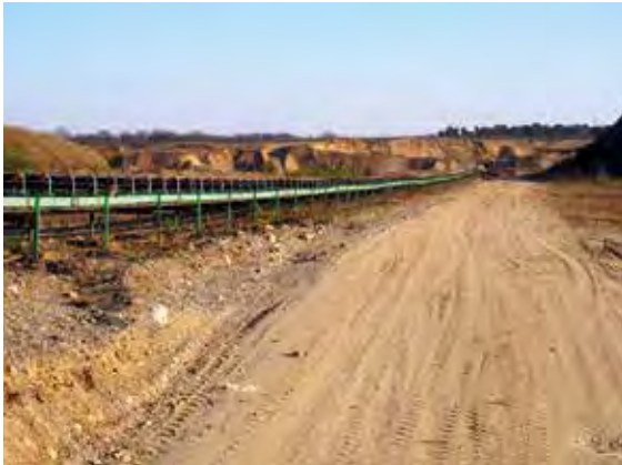
Das langgestreckte Abbaufeld Hallalit versorgt das benachbarte KW Langhagen über ein 1 km langes Förderband mit Rohkiessand, Foto: BGR.
