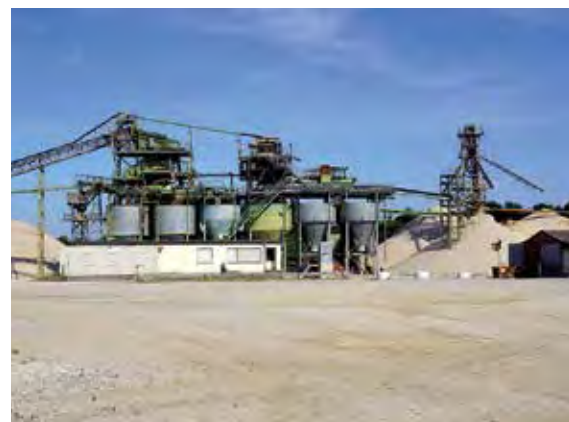
Ein Kieswerk ohne Abbaufächen. Das KW Weeze-Wemb bereitet seit Anfang 2022 nur noch zugekauften Rohkies für einen langjährigen Stammkunden auf – das hochwertige Quarzkiessandvorkommen vor Ort darf nicht weiter genutzt werden Foto: BGR.
