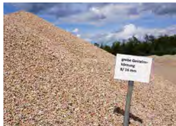
Im KW Babenhausen der Kaspar Weiss GmbH & Co. KG Sand- und Kieswerk werden Mainkiese produziert, die sich durch ihre hohen Gehalte an Quarz- und Buntsandsteingeröllen, letztere aus dem Spessart und Odenwald, auszeichnen, Foto: BGR.
