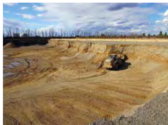
Im KW Reinstedt zwischen Quedlinburg und Aschersleben werden seit knapp 20 Jahren die Kiessande der Oberen Niederterrasse der Selke mittels Radlader abgebaut. Sie kommen zwischen Hannover im Westen und Berlin im Osten zum Einsatz, Foto: BGR.
