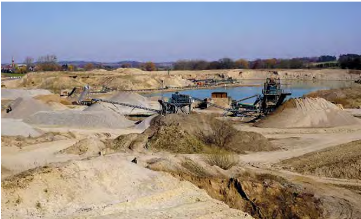
Im KW Charlottenthal der GKM Güstrower Kies & Mörtel GmbH werden Kiessande sowohl im Trockenen wie auch im Nassen abgebaut und zu Gesteinskörnungen für die Betonindustrie sowie den Tief- und Straßenbau aufbereitet, Foto: BGR.
