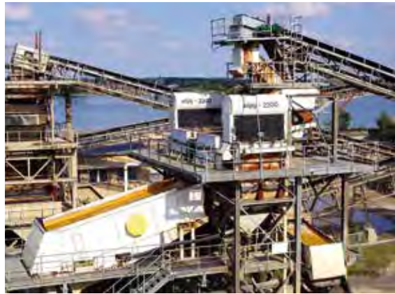
Im KW Sprotta der Niemeier Baustoffgruppe ist die Produktion von kohlefreien Gesteinskörnungen von höchster Priorität. Zur Entkohlung der Kiese kommen hierfür Setzmaschinen des Typs alljig® der Firma allmineral Aufbereitungstechnik zum Einsatz, Foto: BGR.
