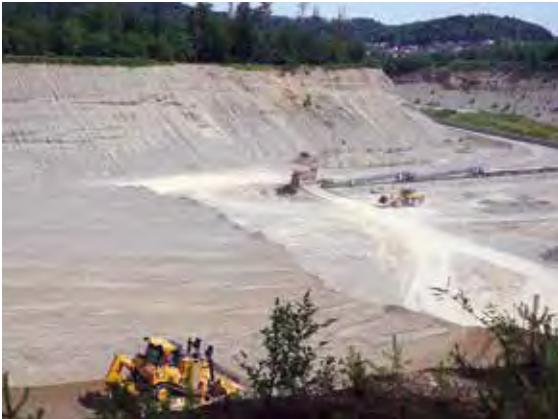
In der Abbaustätte Reutholz des KW Hüntwangen der schweizerischen Holcim Kies und Beton AG wird der bis zu 55 m mächtige Kiessand mit einer Raupe abgeschoben, Foto: BGR.
