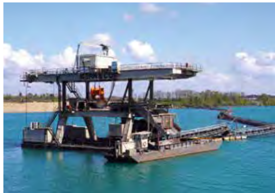
Die Fa. KBI Kieswerk und Baustoff-Industrie Kern GmbH & Co. KG setzt zur Auskiesung einen 8 m 3 -Hydraulikgreifer ein, von dem der Kiessand nach Abtrennung von großen Steinen per Förderband in die Aufbereitungsanlage transportiert wird, Foto: BGR.
