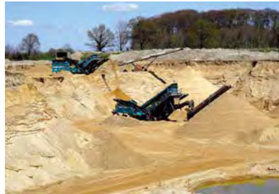
Im KW Borstel der Giese Kiesaufbereitungsges. mbH werden die dort bis zu 15 m mächtigen Kiessande sowohl aus zwei Baggerseen, als auch im Trocken gefördert, Foto: BGR.
