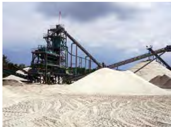
Mit Hilfe von Aufstrom- und Freifallklassierern werden im KW Siebenbergen sieben verschiedene Sandsorten erzeugt, Foto: BGR.
