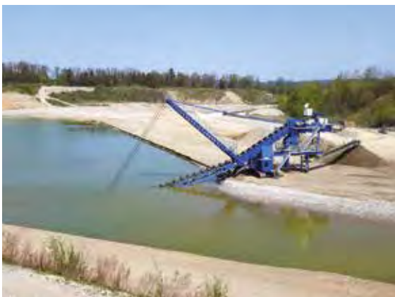
Im KW Raitenhart ist ein landgestützter Eimerkettenbagger in Betrieb, wie er in Bayern häufig zu finden ist, Foto: Inn-Kies Altötting-Mühldorf GmbH & Co. KG (mit frdl. Genehmigung).
