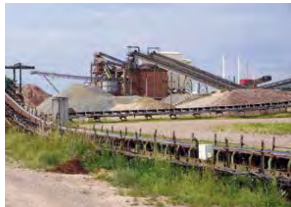
Im KW Erfurt-Nord der K+B Kies und Beton GmbH werden vornehmlich Gesteinskörnungen für die unternehmenseigenen Transportbetonwerke produziert, Foto: BGR.
