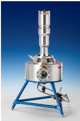
Abb. 2: Gerät zur Bestimmung der Normspaltweite nach ISO/IEC 80079-20-1
