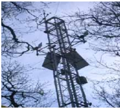
... Flux Tower zur Erfassung der Nettoprimärproduktion über Messungen der Stoffflüsse ...
