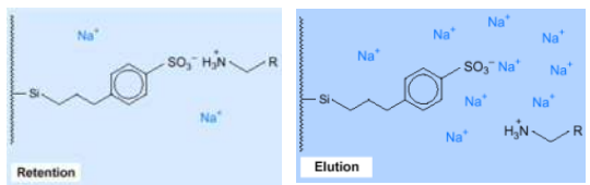
Abb. Retention und Elution mit einem Kationenaustauscher
