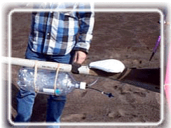
Abb. Bsp. zur Probenahme mit PTFE-Beuteln, Bestimmung gasförmiger Komponenten in Vulkanemissionen
