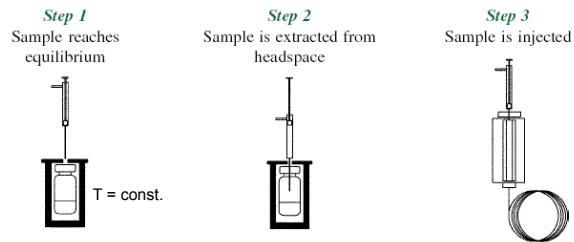
Abb. Vorgehensweise bei der statischen Headspace
