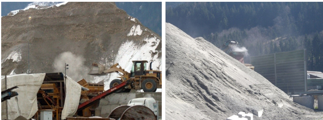
Abbildung 5: Beispiel für die Materialeigenschaft a=3,2 leicht bis deutlich staubend
