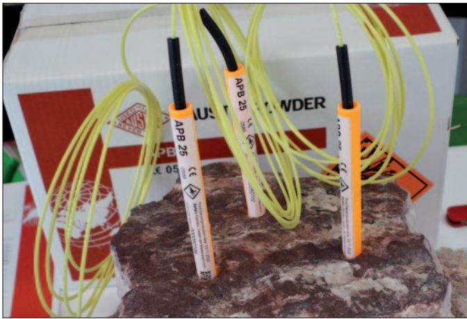
Internationale Tagung für Sprengtechnik 2022: Minibooster (Verstärkerladungen) von Austin Powder; Sprengzubehör
