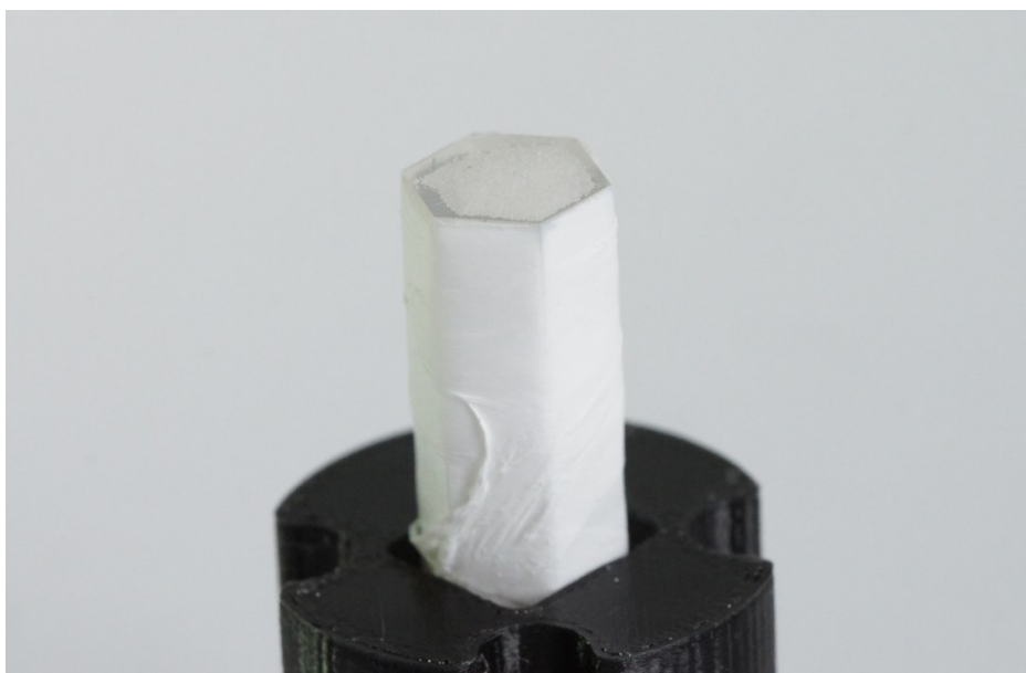
Abbildung 11: Umwickeltes Quarzprisma mit BeO-Pulverbeschichtung auf der Stirnseite für die H'(0,07) –Sonde
