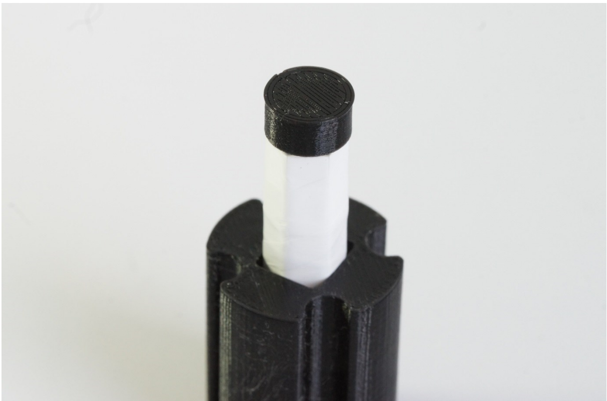
Abbildung 7: Sensor mit aufgesetzter H^*(10) –Kappe
