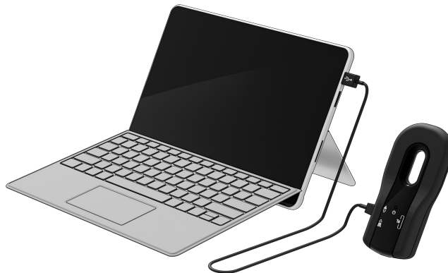
Kuva 5. Vercise PC- ja Vercise Gevia -järjestelmät: Klinikon ohjelmointilaitte (CP) ja ohjelmointikynä
