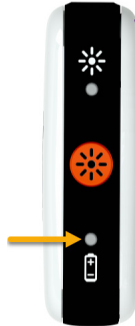
4. ábra ETS akkumulátor-töltöttségjelző
