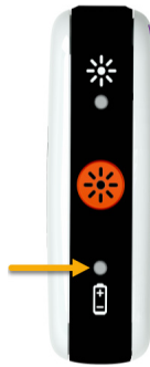
Figura 4. Indicator luminos pentru baterie ETS
