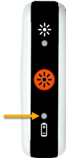
Figura 4. Luz Indicadora da Bateria ETS
