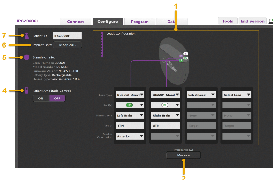
Εικόνα 12. Διαμόρφωση ενός διεγέρτη 32 επαφών
